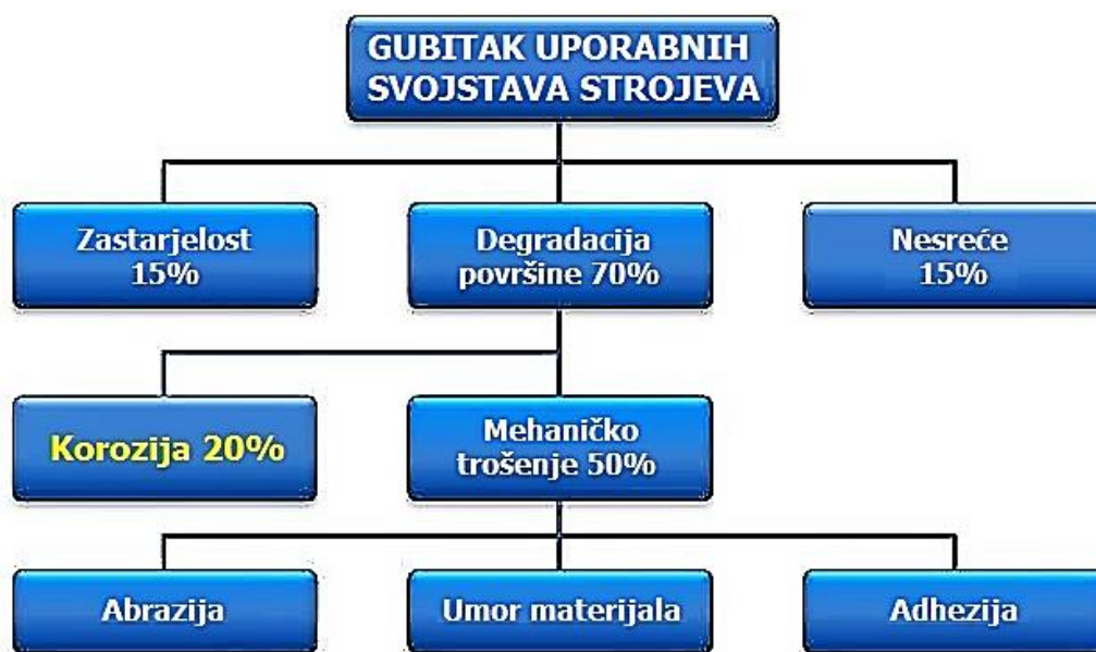
Slika 1. Uzroci gubitka uporabnih svojstava strojeva (Izvor: Noria Corp., 2013.)
