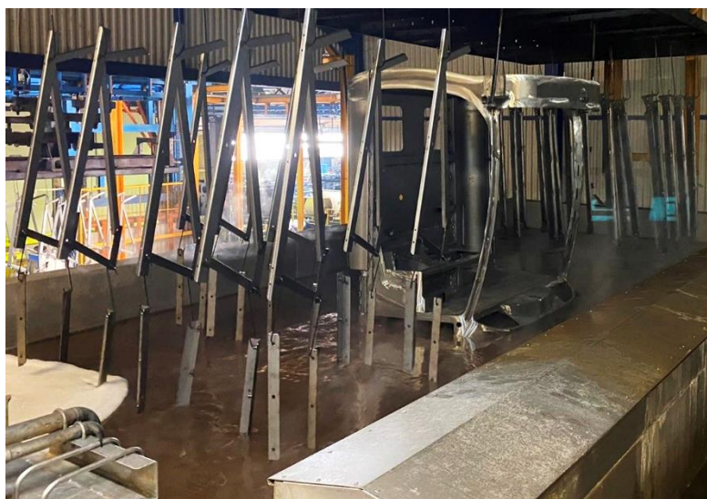
Slika 16. Kada za kataforezu s ovješnim dijelovima (Izvor: Dugonjić, 2021.)
