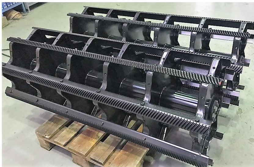
Slika 13. Dio žitnog kombajna obojan u Pogonu kataforeze (Izvor: Dugonjić, 2021.)
