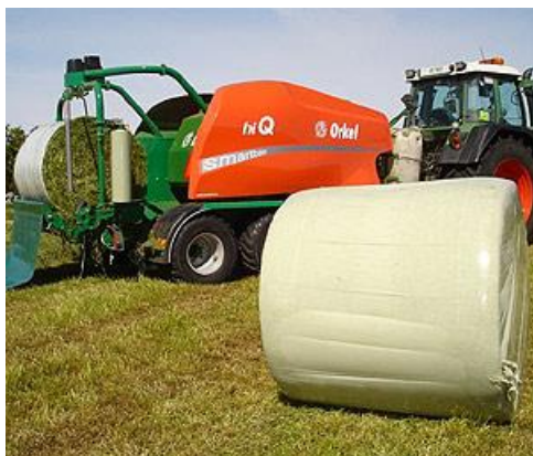
Slika 18. Omatanje sjenaže plastičnom folijom
