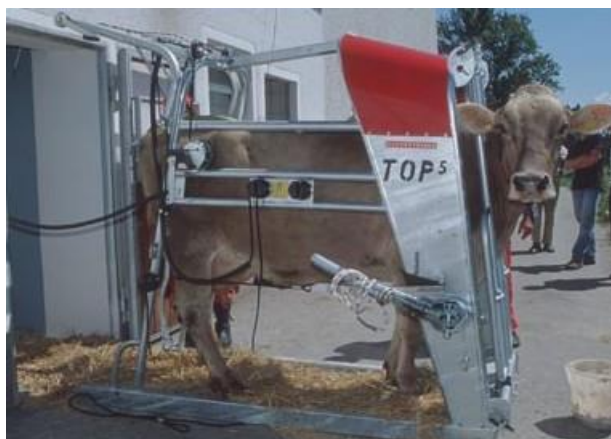
Slika 4. Stroj za orezivanje papaka
