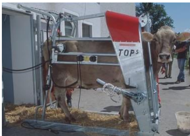
Slika 4. Stroj za orezivanje papaka
