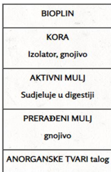
Slika 17. Raspored slojeva u fermentoru
