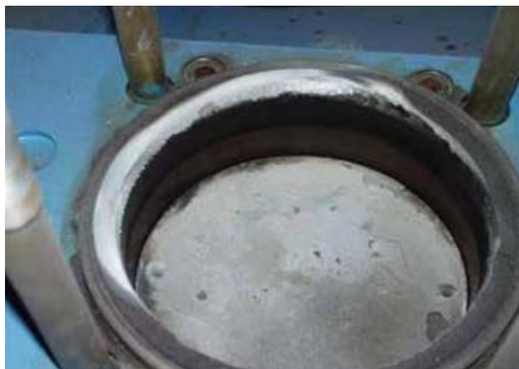
Slika 26. Naslage silicija na klipno – cilindarskom sklopu
