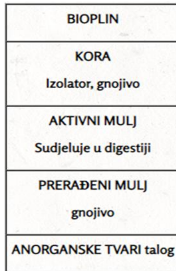
Slika 17. Raspored slojeva u fermentoru
