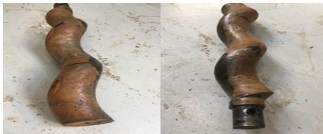
Slika 18. Kavitacijska korozija rotora Biomix crpke
