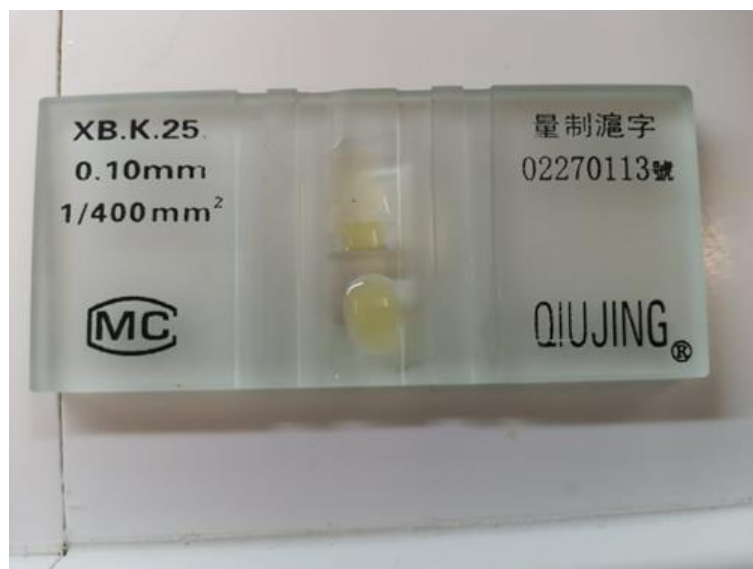
Slika 7. Hemocitometar pripremljenim preparatom za gledanje pod mikroskopom
