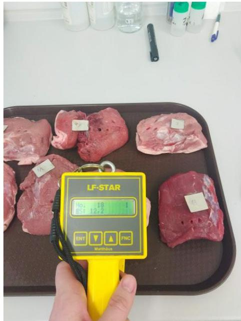
Slika 5. Mjerenje električne provodljivosti LF Star uređajem
