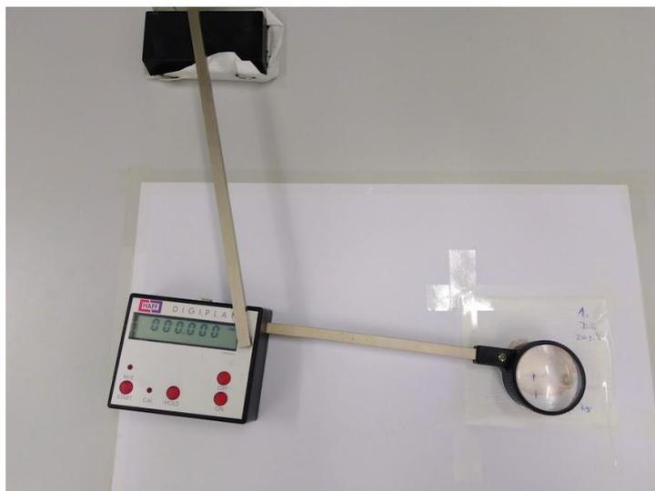
Slika 7. Mjerenje površine istisnutog mesnog soka planimetrom
