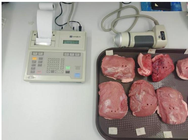
Slika 6. Uređaj za mjerenje komponenti boje (Minolta CR-300)
