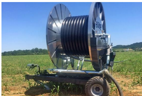
Slika 11. Tifon sustav za navodnjavanje
