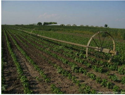
Slika 7. Bočno kišno krilo (Izvor: https://img.halooglas.com )
