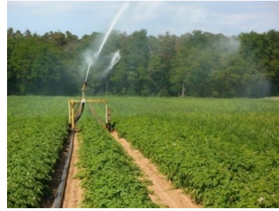
Slika 8. Samohodni sektorski rasprskivač (Izvor: www.agroklub.ba )
