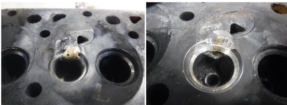
Slika 21. Reparaturno zavarivanje glave motora traktora
