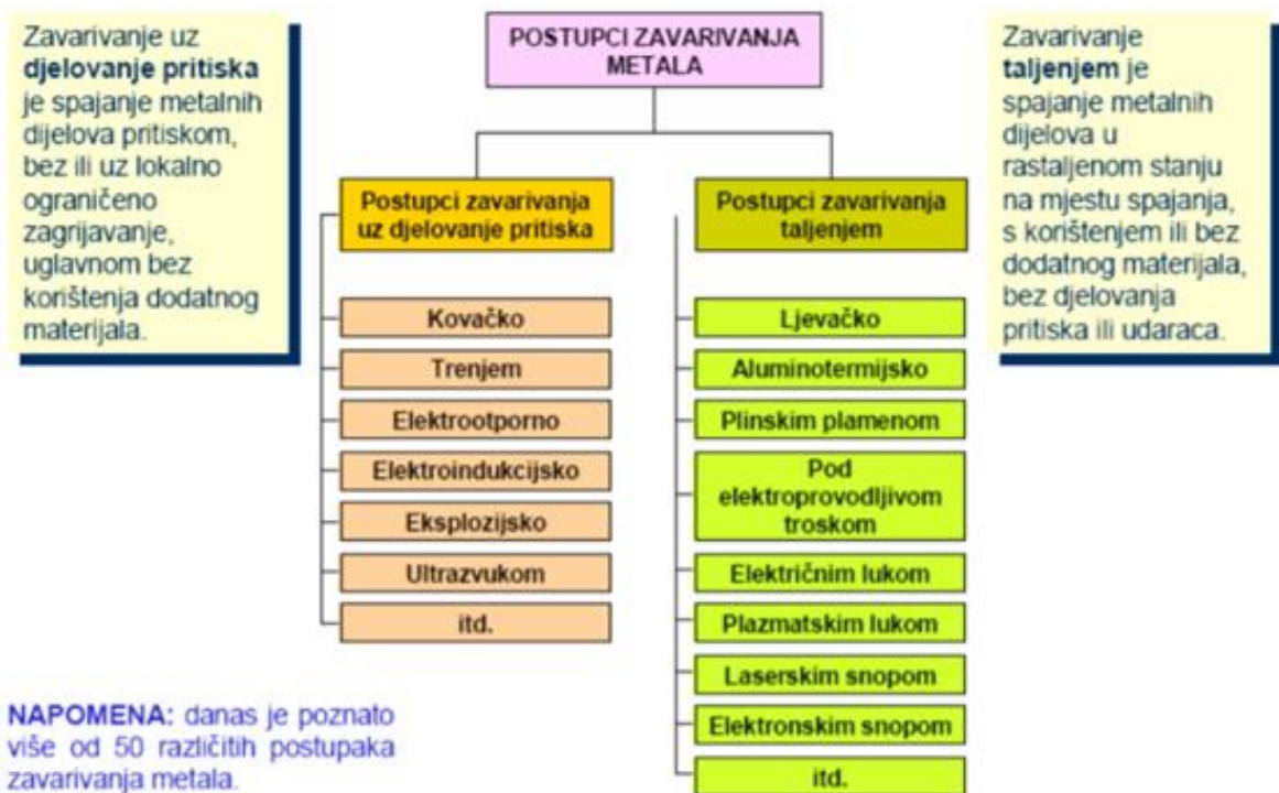
Slika 13: Postupci zavarivanja metala (Izvor: Jeftinija, 2007.)
