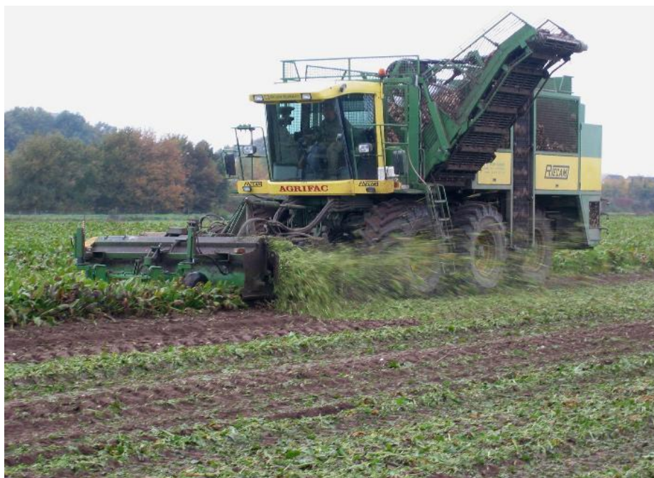
Slika 18. Stroj za vađenje šećerne repe
