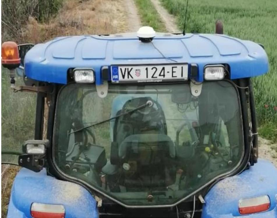
Slika 6. GPS antena (izvor: vlastita fotografija)
