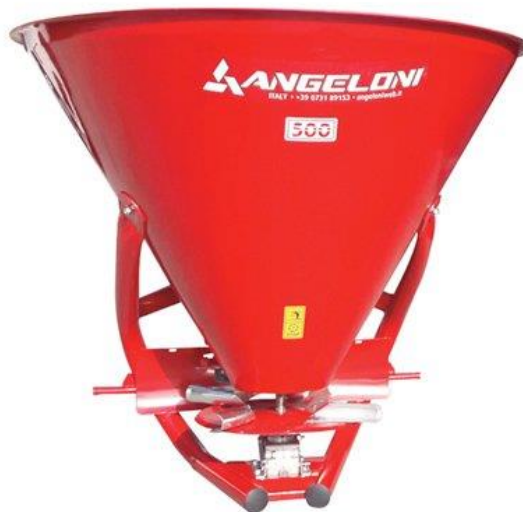
Slika 1. Angeloni raspodjeljivač s jednom rotirajućom pločom (izvor: http://www.baric.hr/wp-content/uploads/2019/03/Centrifugalni-rasipa%C4%8Di-jedan-disk.pdf )
