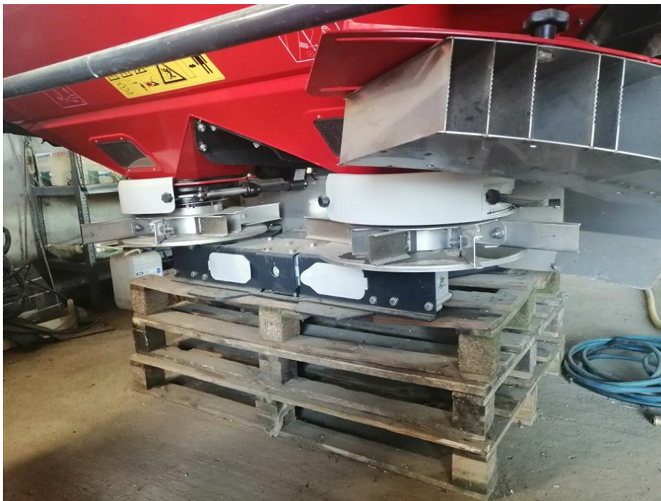
Slika 2. Kverneland rasipač mineralnog gnojiva s dvije rotirajuće ploče (izvor: vlastita fotografija)
