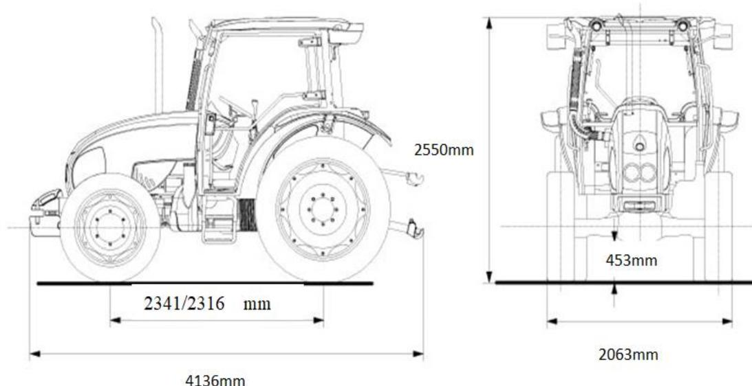
Slika 5. dimenzije traktora Landini Powerfarm DT1000 (Slika uređena)
