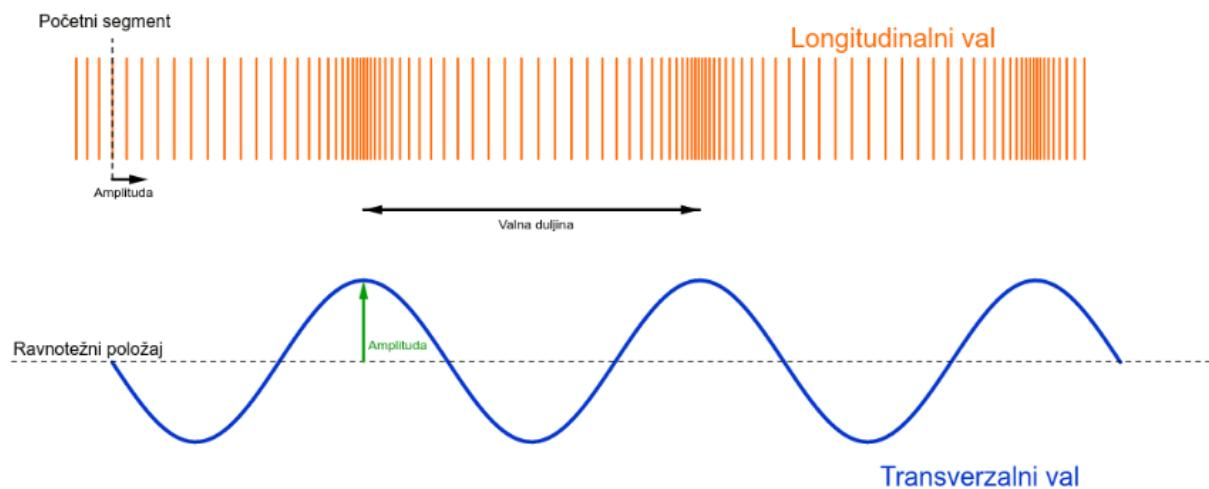
Slika 1. Zvuk kao longitudinalni i transverzalni val
