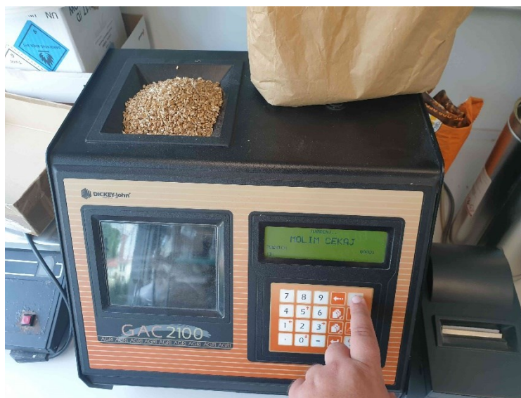
Slika 12. Uređaj za određivanje hektolitarske mase (izvor: Šormaz, S.)
