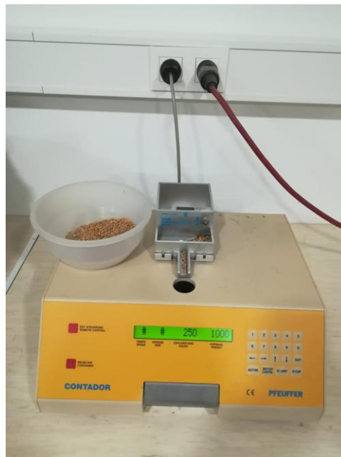
Slika 9. Određivanje mase 1000 zrna (izvor: Rastija, I.)
