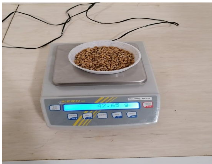
Slika 7. Laboratorijska vaga (izvor: Lešić, M.)
