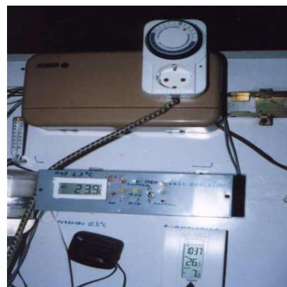
**Slika 4. Modul za regulaciju vlage zraka –higrostat**
