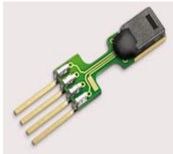
**Slika 7.** Sensirion SHT 75 senzor,
