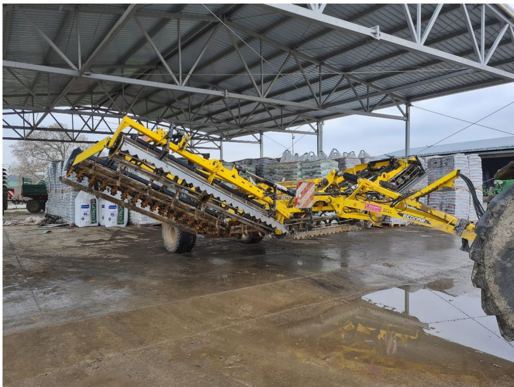
Slika 8. Stroj za dopunsku obradu tla- Bednar Swifter SO8000
