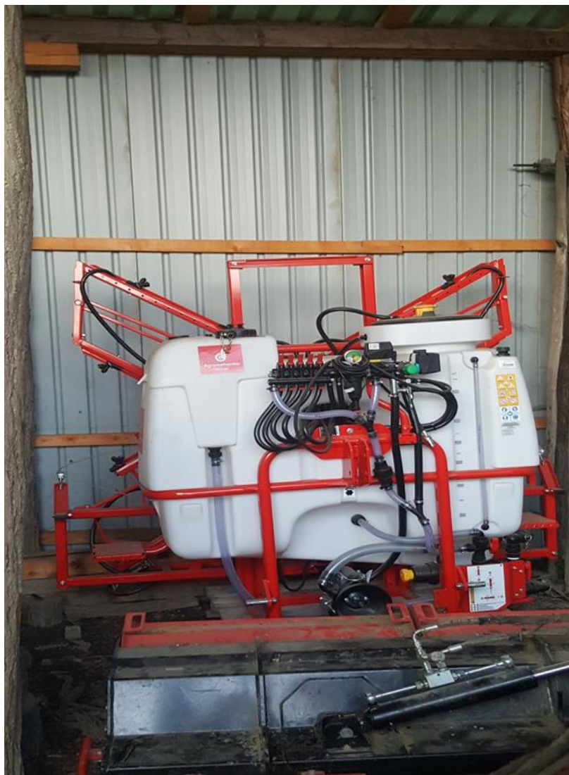
Slika 21. Prskalica AGS 600 EN korištena u zaštiti (Izvor Pipek, M.)
