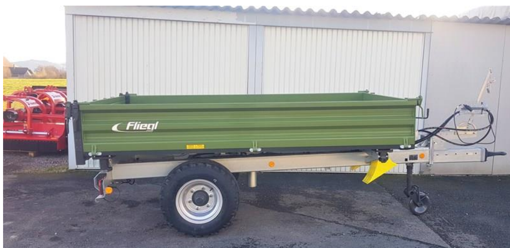
Slika 26. Jednoosovinska prikolica Fliegl EDK 40 FOX
