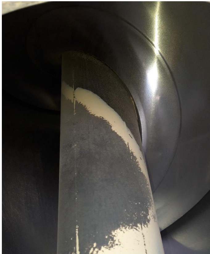
Slika 40. Zavojnica puža na prikolici Fliegl Gigant ASW 271
