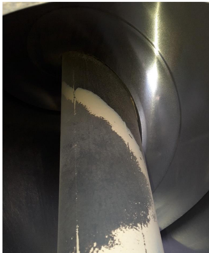
Slika 40. Zavojnica puža na prikolici Fliegl Gigant ASW 271
