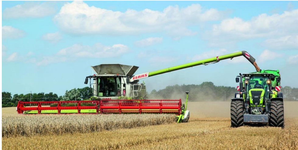
Slika 16. Cijev za pražnjenje u radnom položaju
