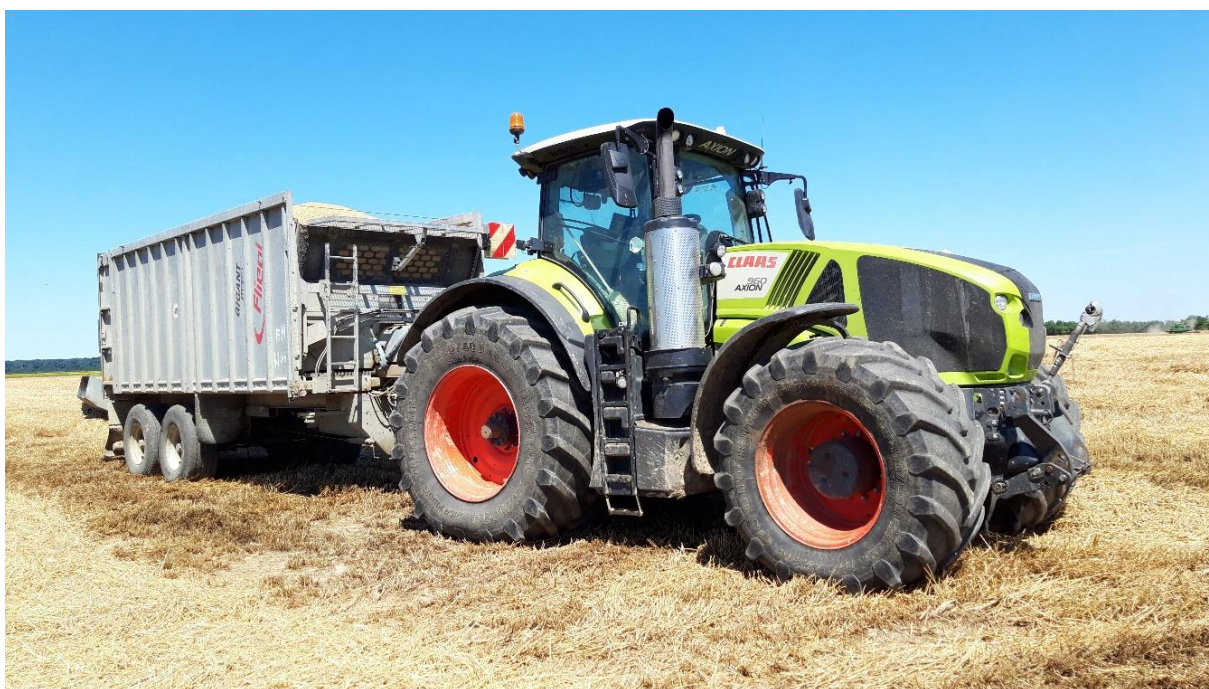
Slika 23. Transportno-pretovarni agregat: traktor Claas Axion 960 + pretovarna prikolica Fliegl Gigant ASW 271 (Izvor: vlastita fotografija)
