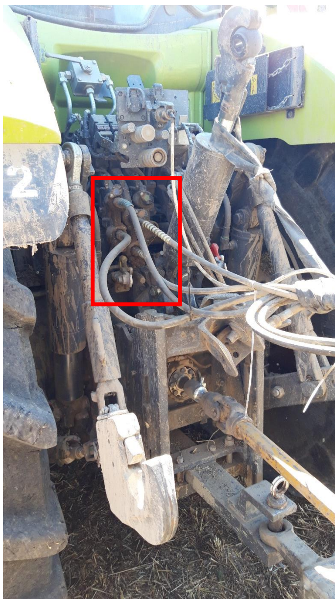
Slika 34. Pneumatske instalacije na traktoru Claas Axion 960
