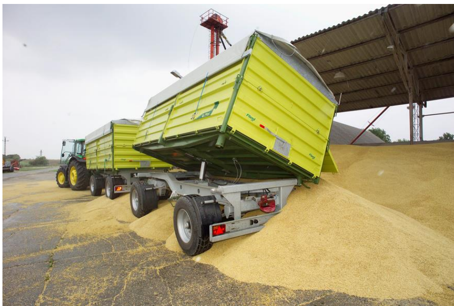
Slika 28. Istovar robe na desnu stranicu kod prikolice Fliegl DK 140-88
