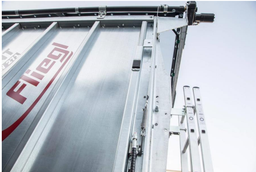
Slika 31. Stranica izrađena od pocinčanog lima
