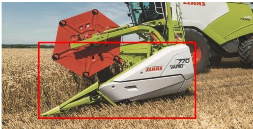
Slika 3. Europska izvedba razdjeljivača na hederu Claas Vario 770
