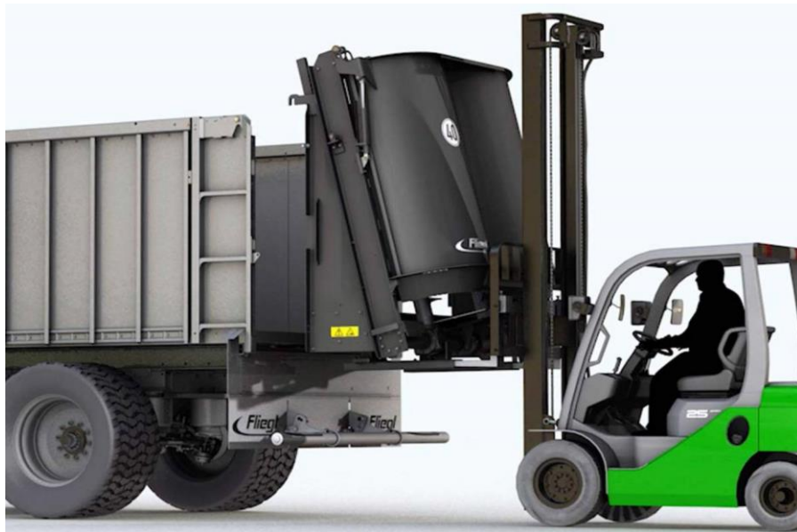
Slika 30. Zamjena zadnje stranice pomoću malog viličara
