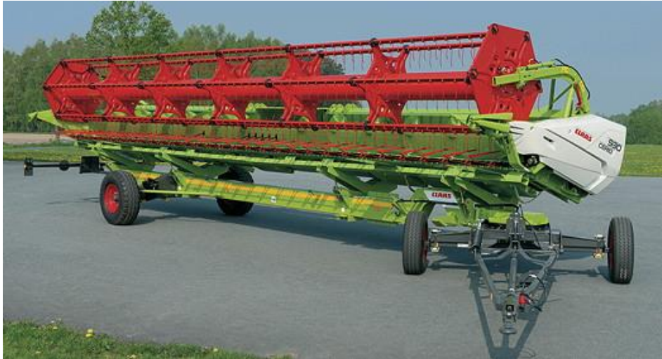
Slika 2. Heder Claas Cereo 930 postavljen na transportnu prikolicu
