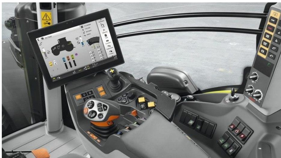
Slika 25. CEBIS sustav u kabini traktora Claas Axion 560
