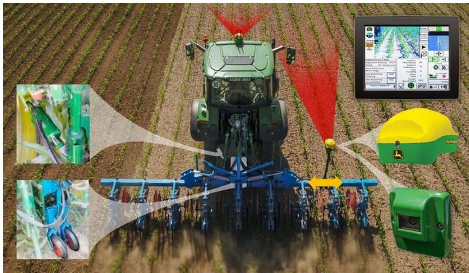
Slika 38. Položaja kamera u sustavu John Deere AutoTrac Vision
