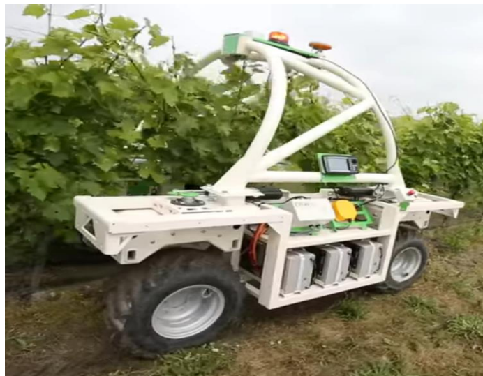
Slika 65. Naïo robot, prorjeđivanje lišća u vinogradu
