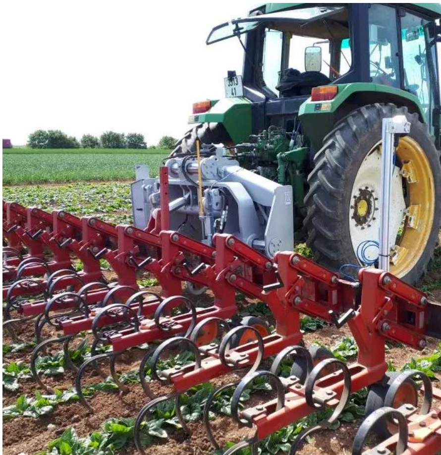
Slika 56. Dynatrac poteznica sa kamerom za reduciranje zanošenja priključka (Izvor: https://www.laforgegroup.com/en/dynatrac-2/ )
