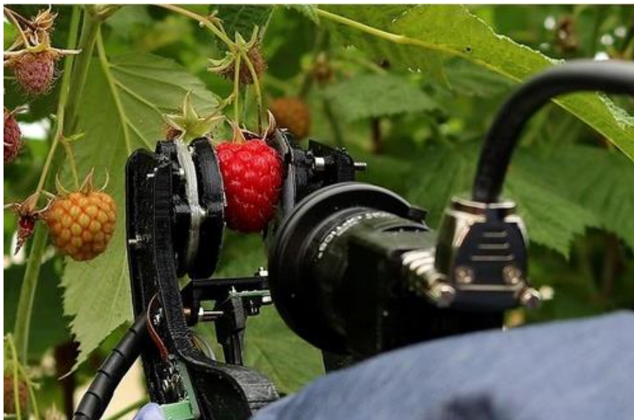
Slika 30. Meki manipulator za branje malina
