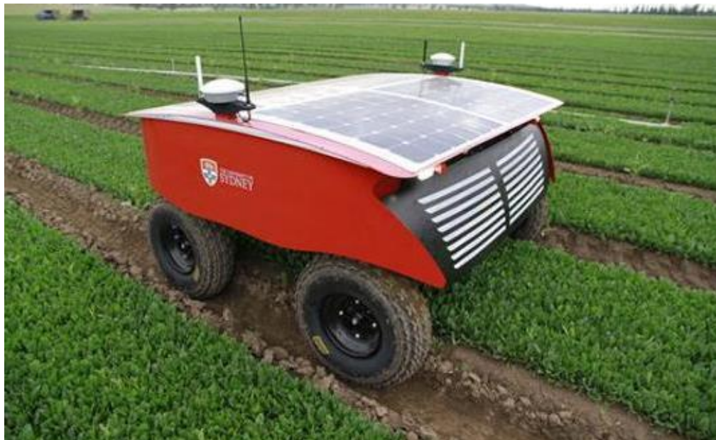
Slika 63. Rippa robot, kemijsko suzbijanje korova (Izvor: https://robot.cfp.co.ir/en/newsdetail/335 )
