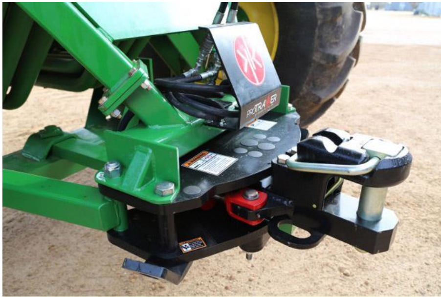
Slika 55. ProTrakker priključak priključna poteznica za upravljanje priključkom (Izvor: http://www.protrakker.com/400DB-system/default.aspx )
