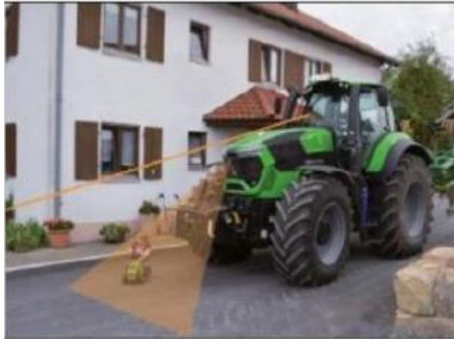
Slika 34. Produljeni vid slijepog kuta vozača na traktoru Deutz Fahr
