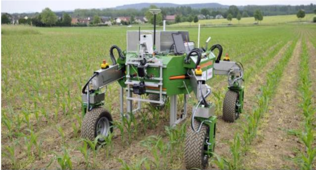
Slika 58. BoniRob robot vrši pregled usjeva
