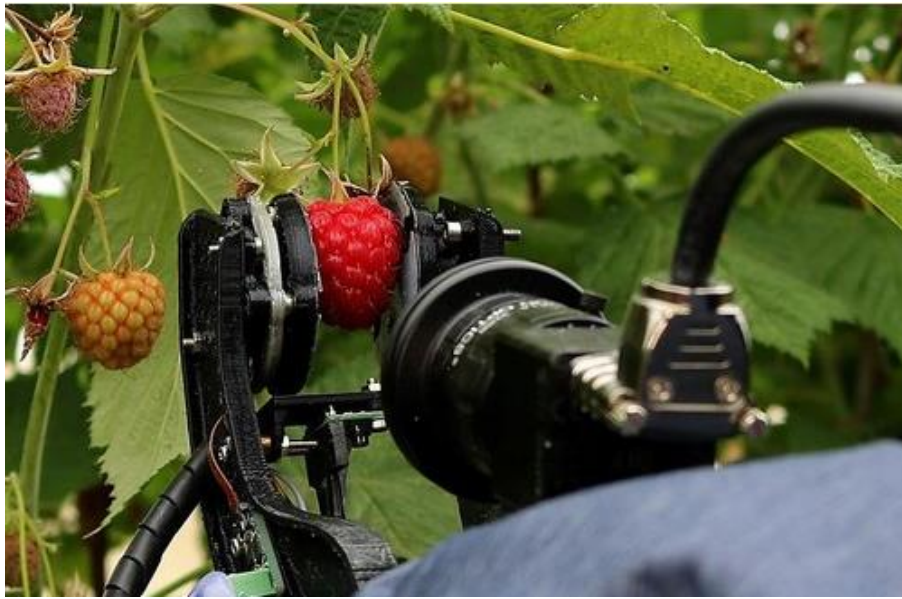
Slika 30. Meki manipulator za branje malina
