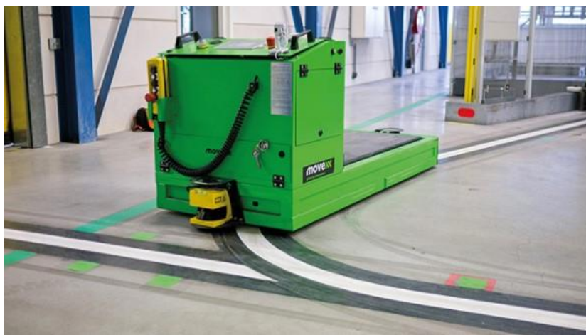
Slika 8. Magnetna traka za navođenje
