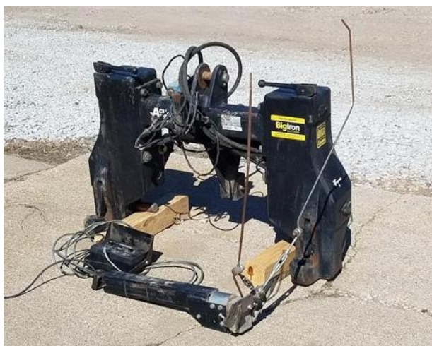
Slika 57. Acura Trak priključni sustav za upravljanje priključkom (Izvor: https://www.bigiron.com/Lots/SuncoAcuraTrak3NE3-PtGuidanceSystem-2 )
