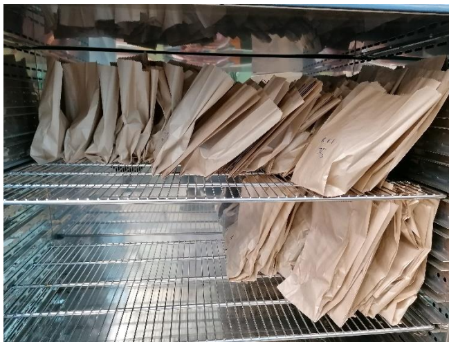
Slika 18. Uzorci postavljeni u sušioniku
