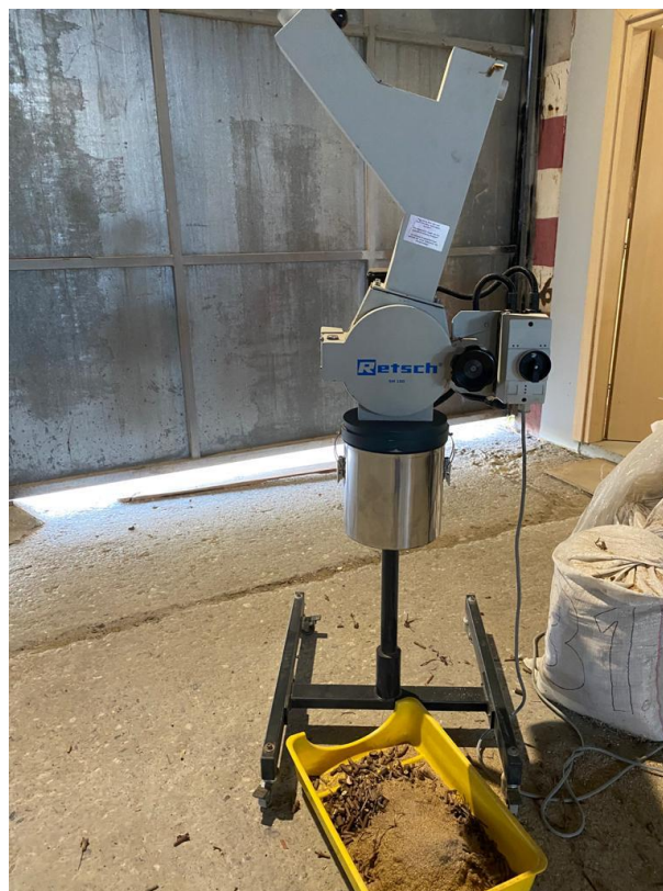
Slika 17. Mlin za biljne materijale
