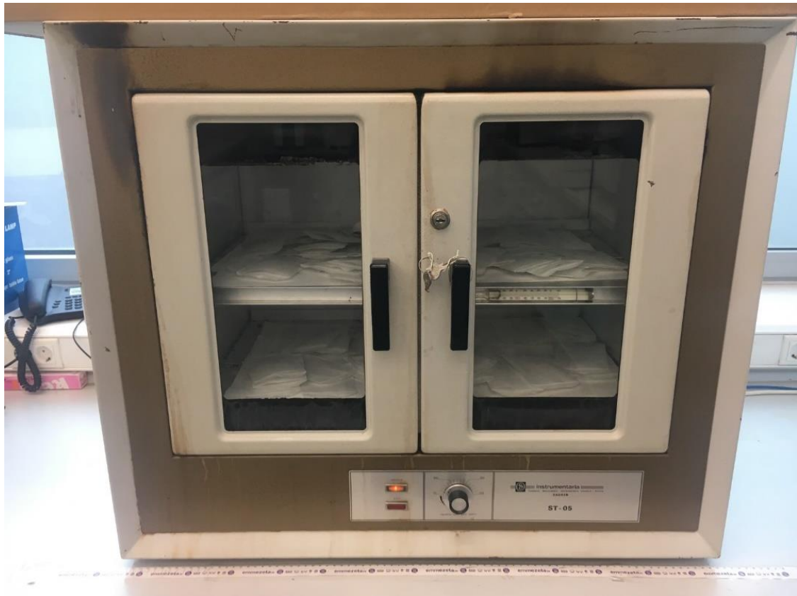
Slika 7. Sušenje uzoraka na temperaturi od 75°C
