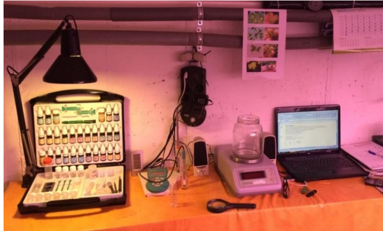
Slika 37. Pribor za utvrđivanje sadržaja dušika u hranjivoj otopini (Izvor: vlastita fotografija, 2017.)
