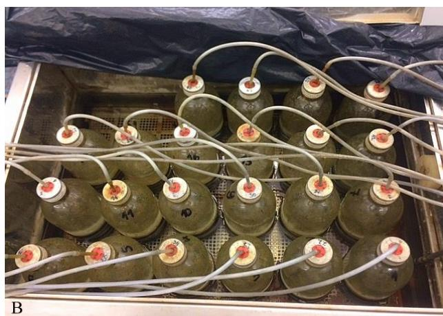
Slika 39. Reaktorske boce u termostatiranoj vodenoj kupelji
