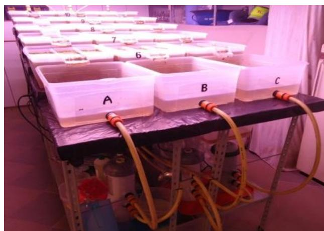
Slika 33. Sustav crpki i preljevnih bazena
