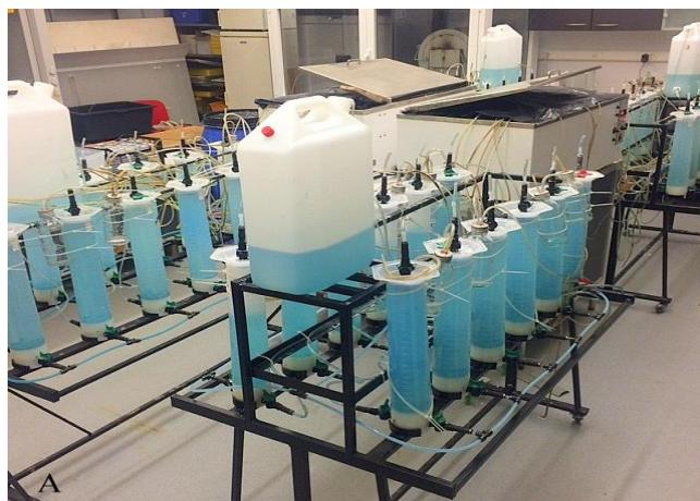
Slika 38. Aparatura za provedbu anaerobne digestije
