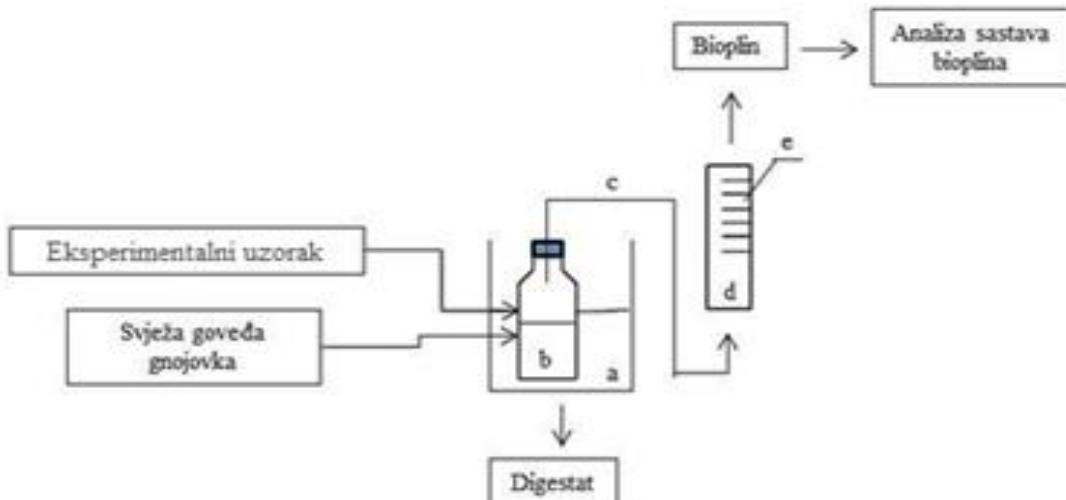
Slika 40. Shematski prikaz provedbe šaržnog procesa anaerobne digestije: a) termostatirana vodena kupelj ( $n=2$ ), b) reaktorska boca ( $n=48$ ), c) gumeno crijevo, d) prezasićena otopina NaCl, e) menzura za prikupljanje bioplina ( $n=48$ )
