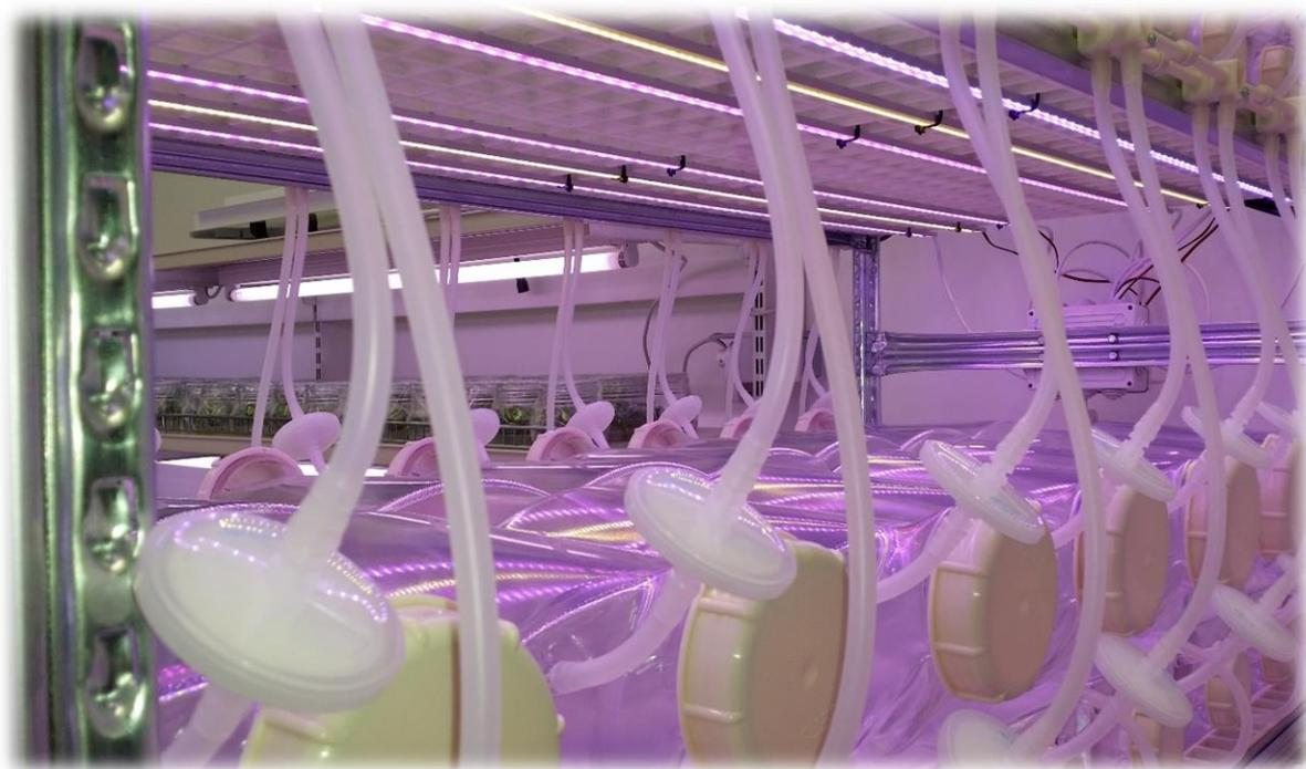
**Slika 10.** Imerzni sustav bioreaktora SETIS, FAZOS (Foto: Bošnjak, 2020.)
