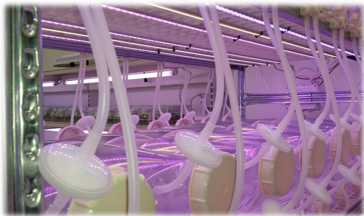
Slika 10. Imerzni sustav bioreaktora SETIS, FAZOS (Foto: Bošnjak, 2020.)
