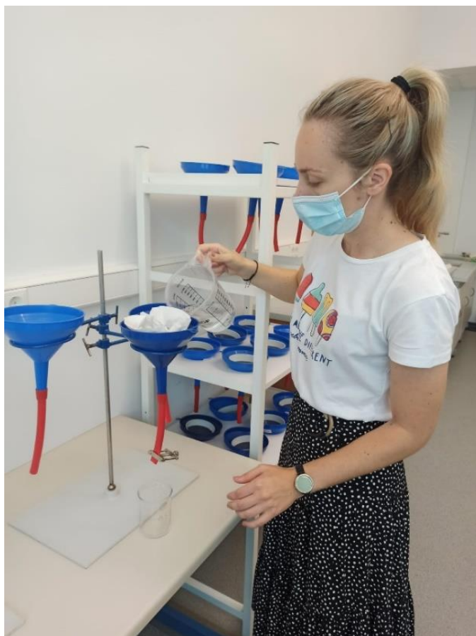
Slika 13. Baermanova metoda lijevka
