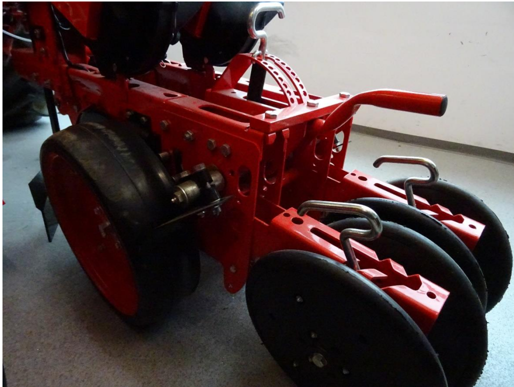
Slika 13. Prikaz sjetvene sekcije sijačice
