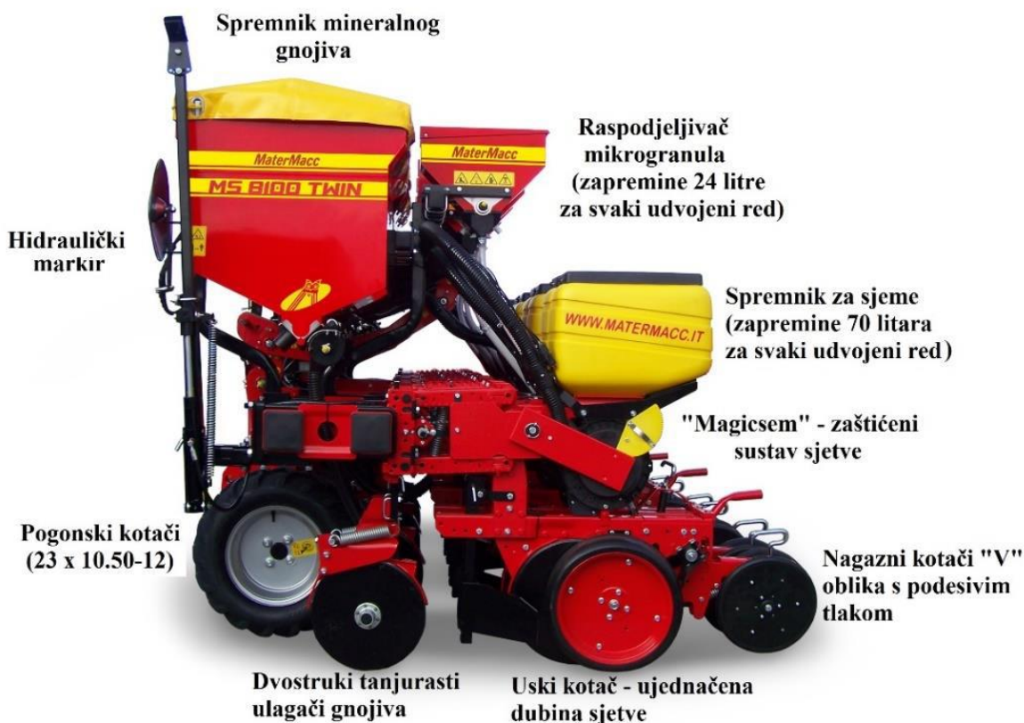
Slika 10. Dijelovi sijačice MaterMacc Twin Row-2
