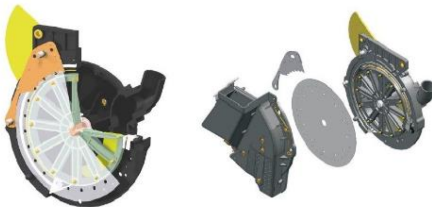
Slika 14. Kućište sjetvenog uređaja (Izvor: Banaj, 2020., str. 41.)
