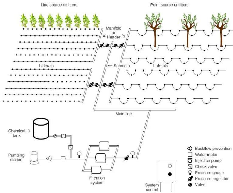
Slika 6. Izgled cijelokupnog sustava za navodnjavanje mirkorasprivačima sa spremnikom za gnojiva
