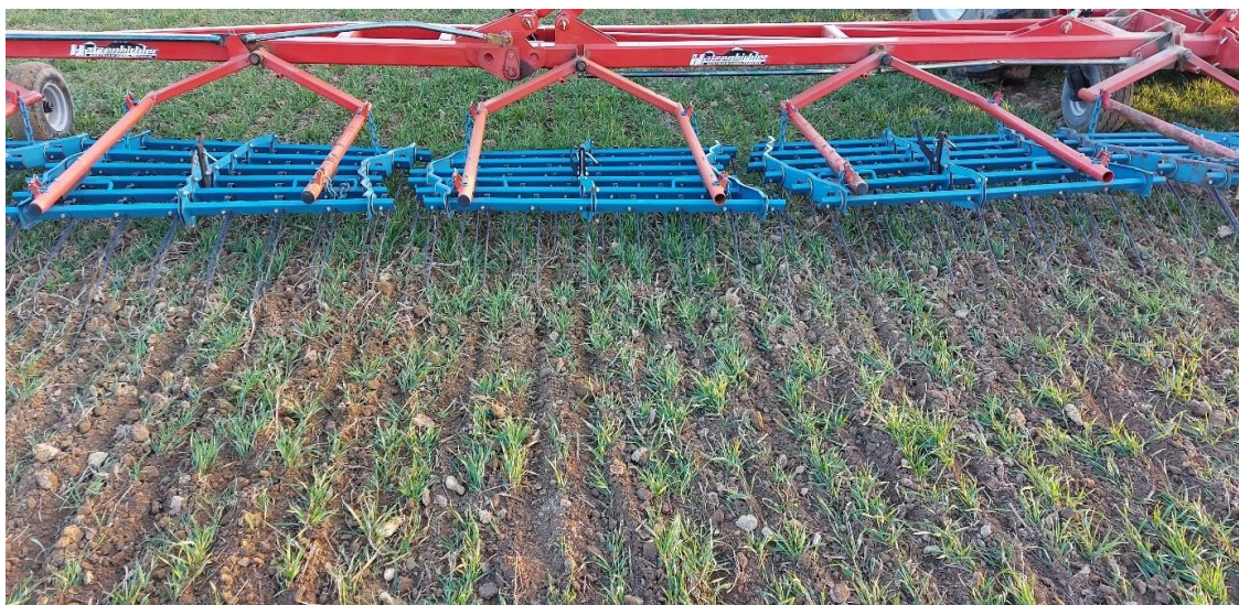
Slika 17. Djelovanje češljaste drljače
