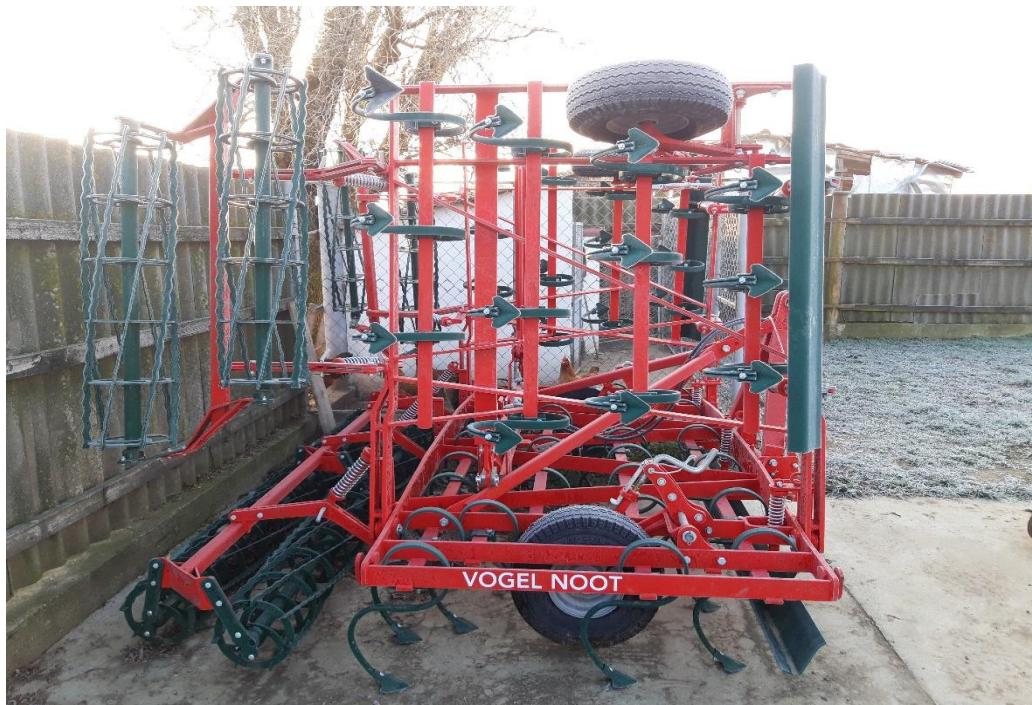
Slika 15. Sjetvospremač za pripremu i sječu korova
