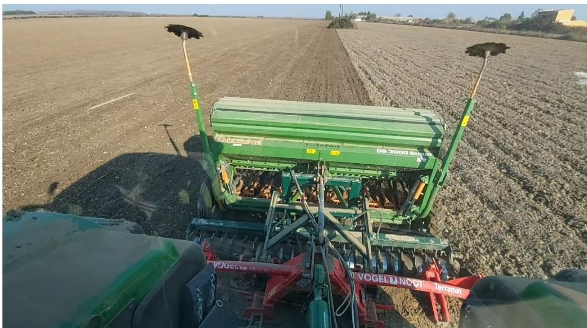
Slika 12. Sjetva pira u kombinaciji sa rotodrljačom
