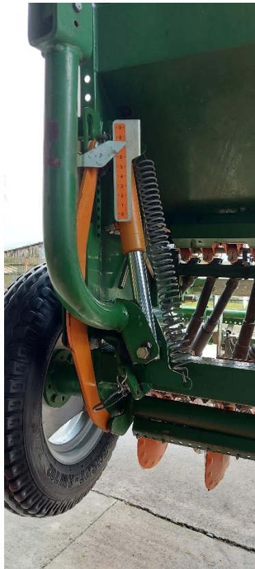
Slika 24. Podešavanje sile na ulagačima sjemena
