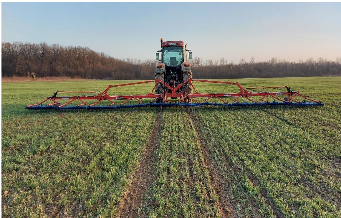
Slika 25. Češljasta drljača u radu
