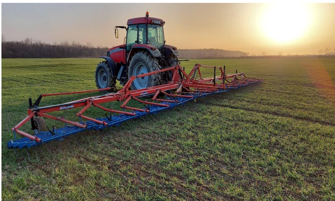
Slika 16. Češljasta drljača u radu
