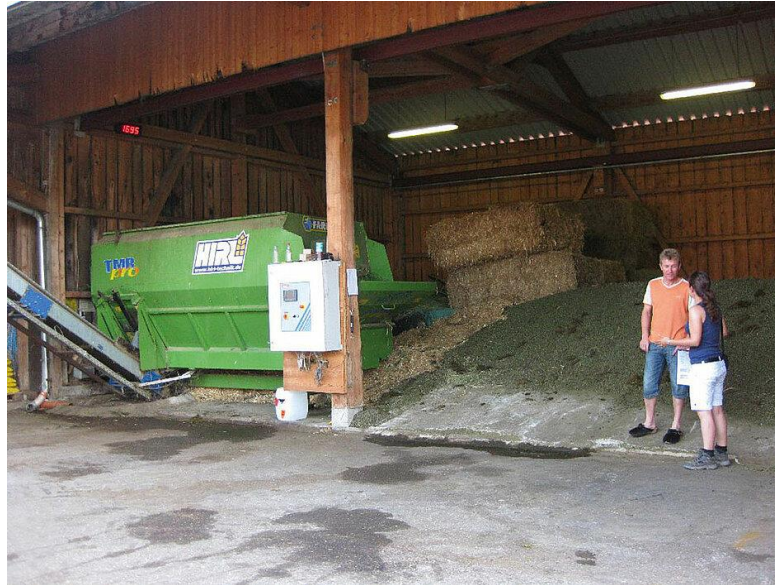
Slika 4. Stacionirana miješalica kao dio robotiziranog sustava pripreme hrane na govedarskoj farmi
