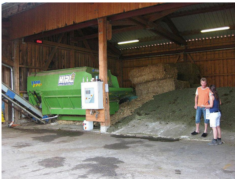
Slika 4. Stacionirana miješalica kao dio robotiziranog sustava pripreme hrane na govedarskoj farmi
