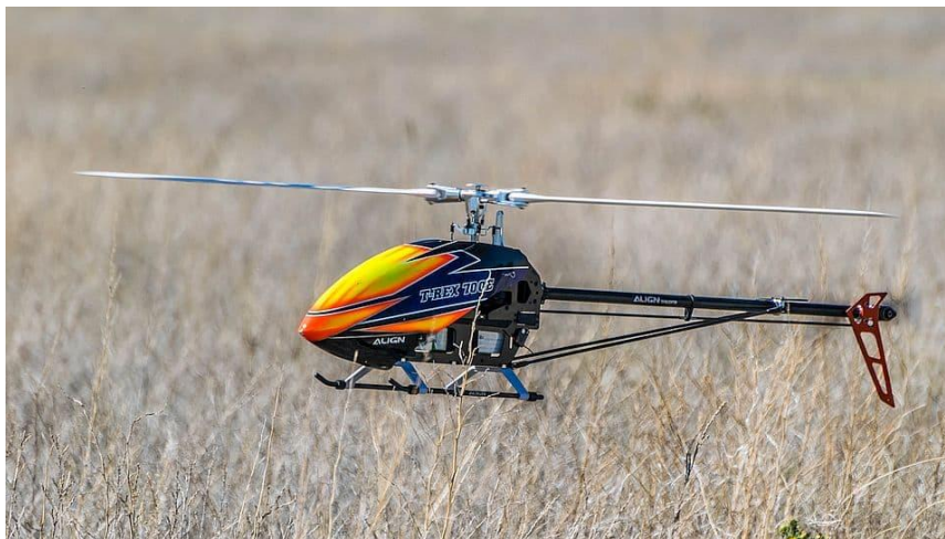
Slika 6. Bespilotni zrakoplov s jednim rotorom pogonjen elektromotorom
