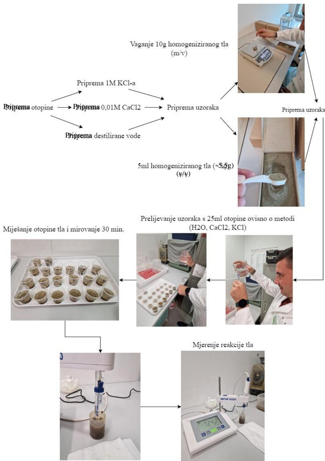
Slika 4. Shematski prikaz metoda za mjerjenje reakcije tla
