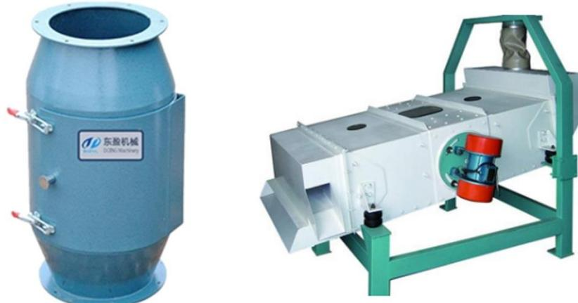
Slika 1. Magnetski separator i sito za čišćenje
