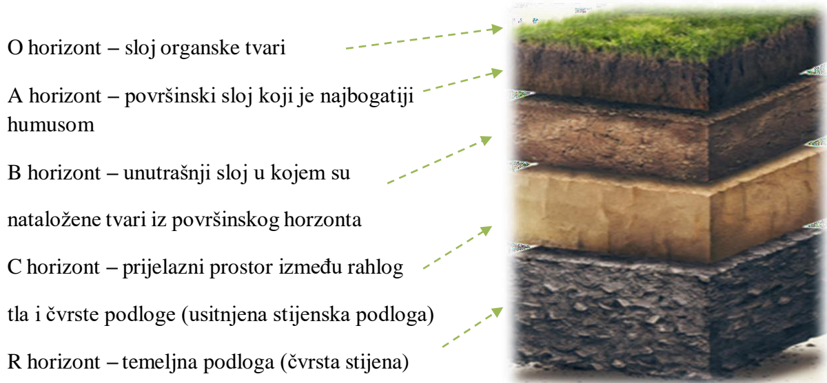
Slika 5. Shematski prikaz pedološkog profila tla (Izvor: https://slidetodoc.com )
