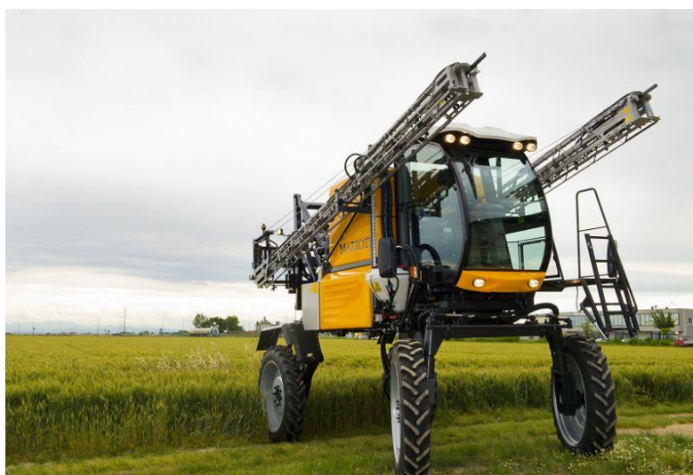
Slika 9. Mazotti samohodna prskalica IBIS 3145 LP
