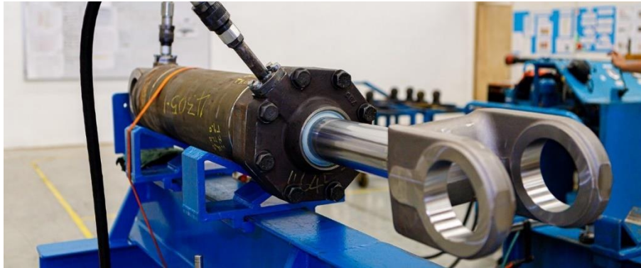
Slika 37. Kompaktni agregat za ispitivanje ispravnosti hidrauličkog cilindra (Izvor: https://www.delhyd.com.au/capability/assembly/ )
