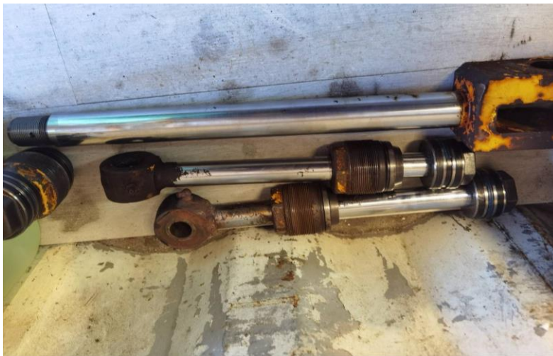
Slika 29. Hidraulički cilindar zahvaćen korozijom
