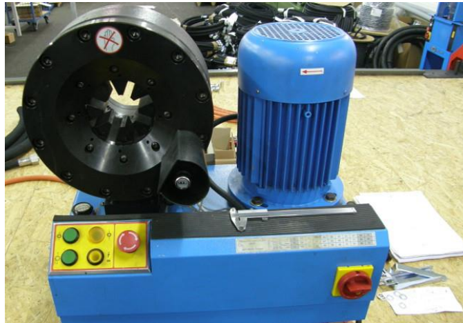
Slika 26. Preša TECHMAFLEX PE 28 za izradu hidrauličkih crijeva
