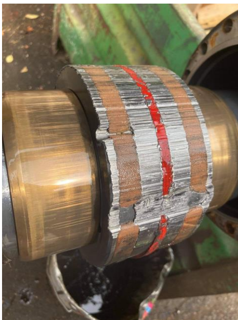
Slika 31. Glava klipa sa potrošenom klipnom brtvom i klizećim prstenovima (Izvor: Vlastita fotografija)
