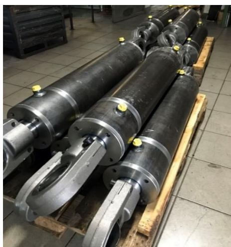
Slika 27. Hidraulički cilindar 180x90 – radni hod 900 mm
