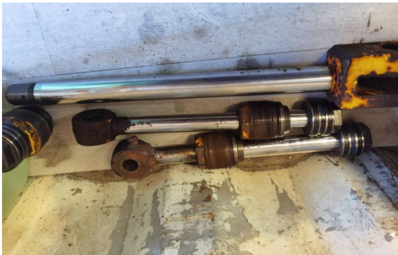
Slika 29. Hidraulički cilindar zahvaćen korozijom
