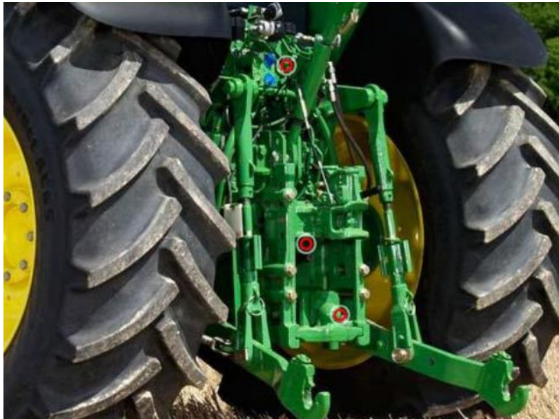
Slika 8. Prikaz standardiziranog priključka traktora- trozglobna poteznica
