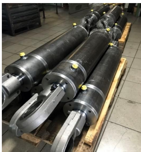
Slika 27. Hidraulički cilindar 180x90 – radni hod 900 mm
