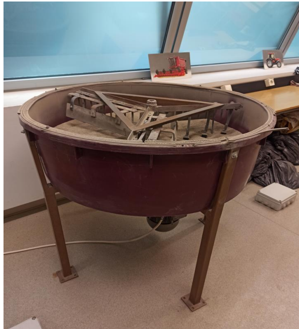
Slika 14. Uređaj za ispitivanje trošenja gibanjem uzoraka u masi abraziva
