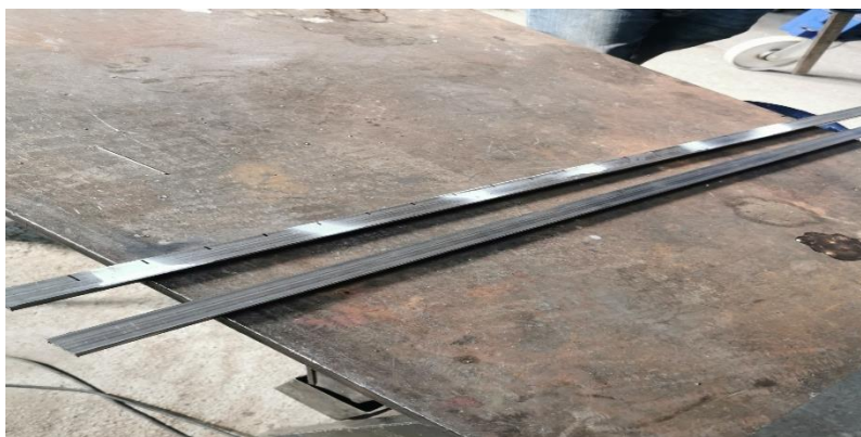
Slika 1. Konstrukcijski čelik s235 koji smo koristili u istraživanju (Izvor: Giber 2022.)
