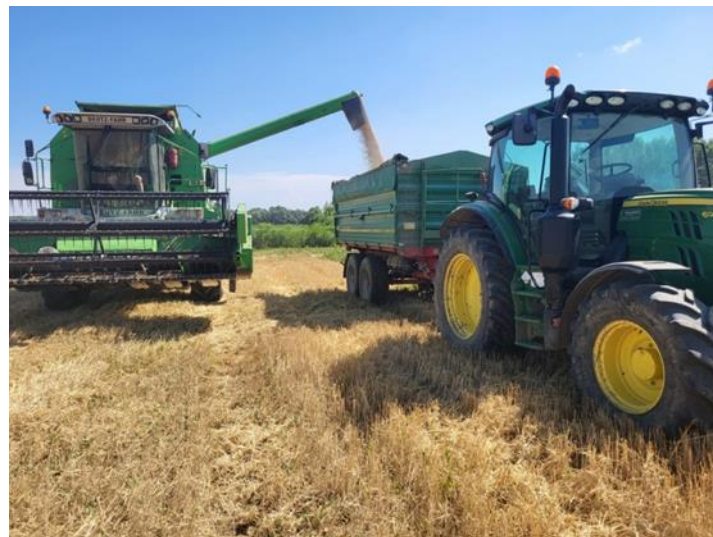
Slika 18. Pražnjenje bunkera kombajna (Izvor: Ante Ljubičić)
