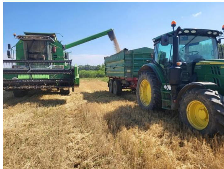
Slika 18. Pražnjenje bunkera kombajna (Izvor: Ante Ljubičić)
