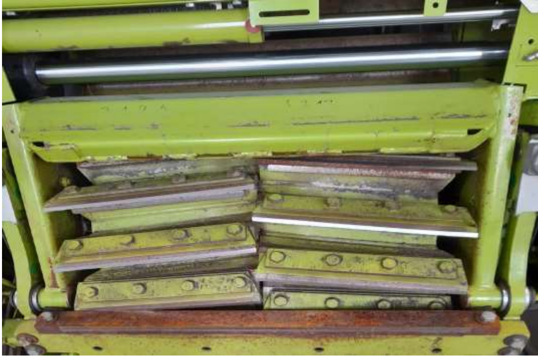
Slika 8. Prikazuje naoštrene noževe sječke (Izvor: Vlastita fotografija)
