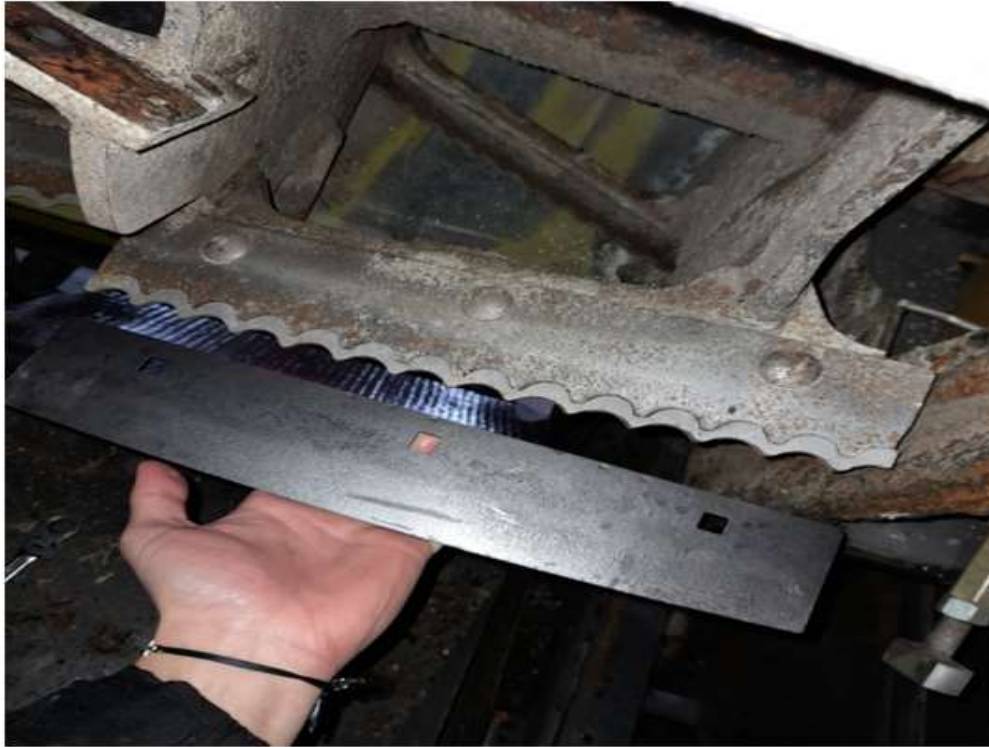
Slika 12. Prikazuje usporedbu novih i starih lopatica akceleratora (Izvor: Vlastita fotografija)
