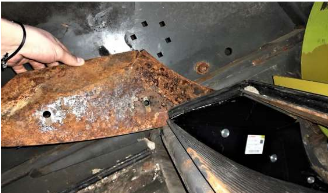
Slika 11. Prikazuje usporedbu istrošene vodilice i nove vodilice biljne mase (Izvor: Vlastita fotografija).
