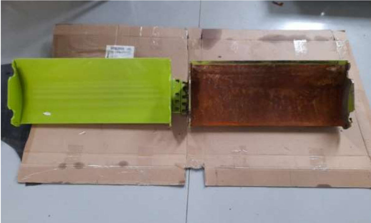
Slika 5. Prikazuje usporedbu Claas premium konkavnog cilindra (lijevo) i istrošenog cilindra koji se nalazio na uvlačnom grlu (desno) (Izvor: Vlastita fotografija)
