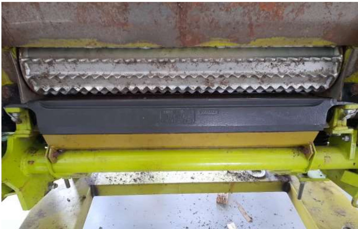
Slika 4. Predstavlja Claas premium čistač glatkog valjka (Izvor: Vlastita fotografija).
