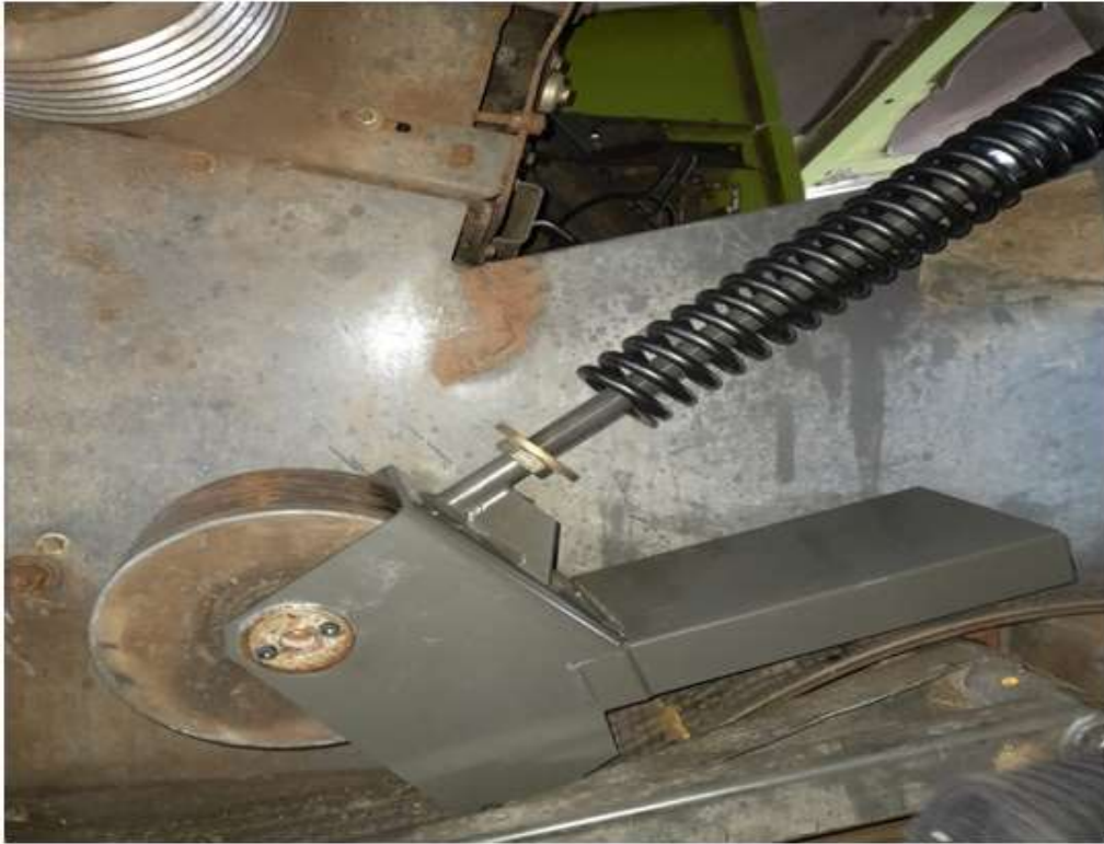
Slika 16. Prikazuje novi zatezač remena i oprugu (Izvor: Vlastita fotografija)
