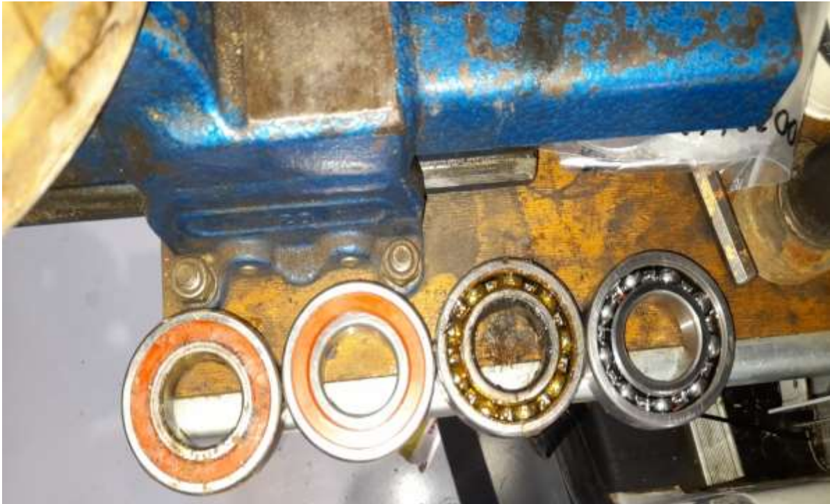
Slika 14. Prikazuje usporedbu istrošenog i novog ležaja prilikom remonta (Izvor: Vlastita fotografija)
