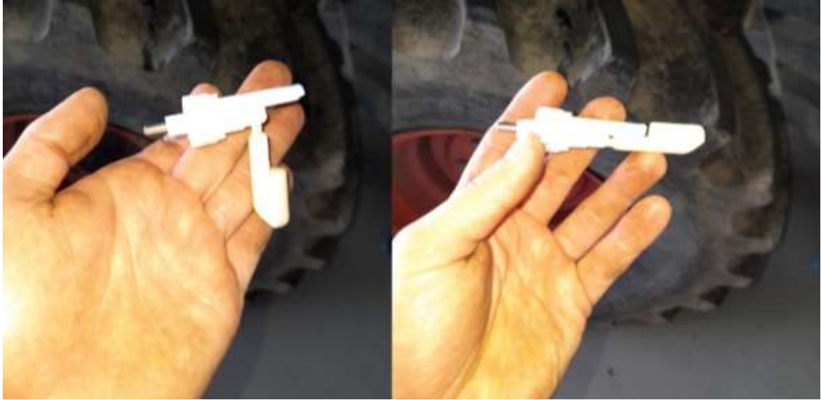
Slika 23. Prikazuje senzor razine rashladne tekućine (Izvor: Vlastita fotografija)
