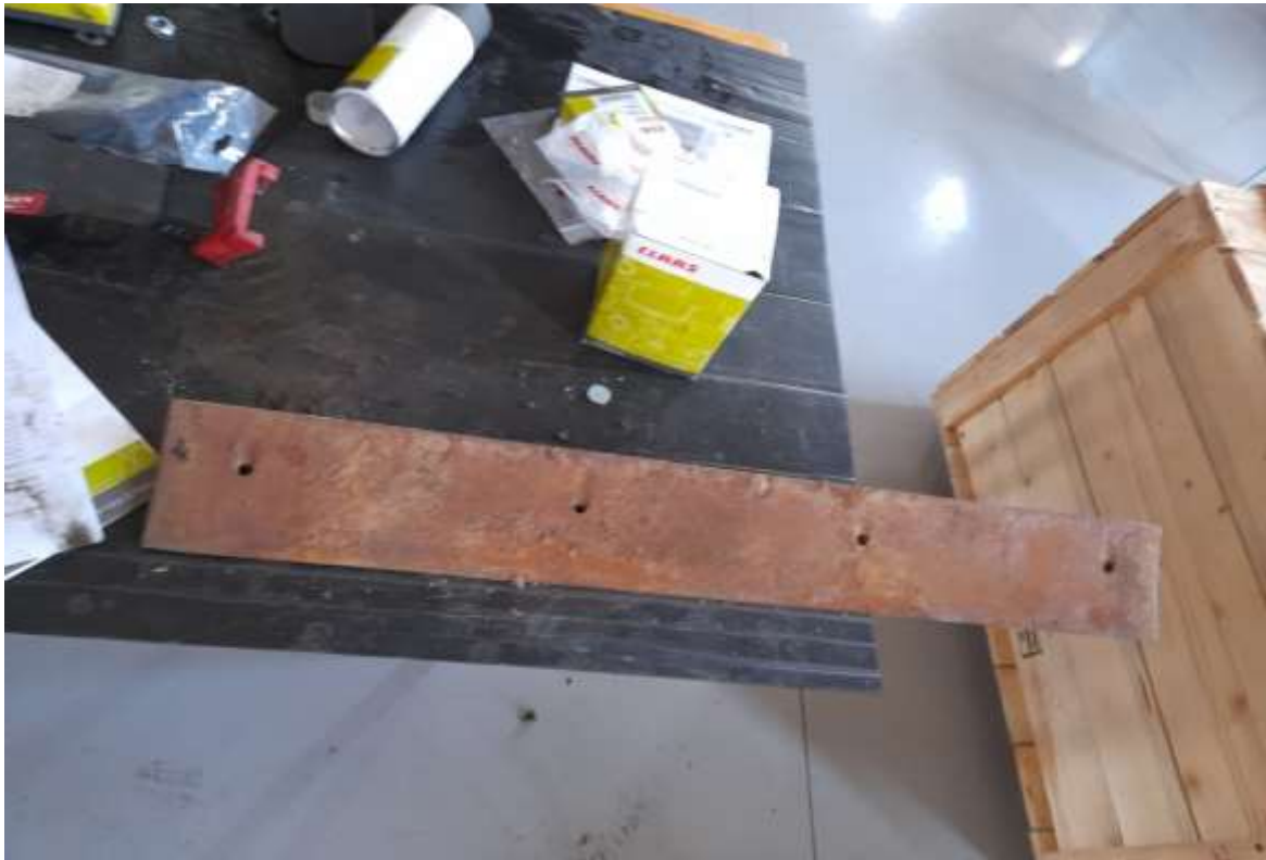
Slika 6. Prikazuje istrošeni čistač kontranoža (Izvor: Vlastita fotografija).
