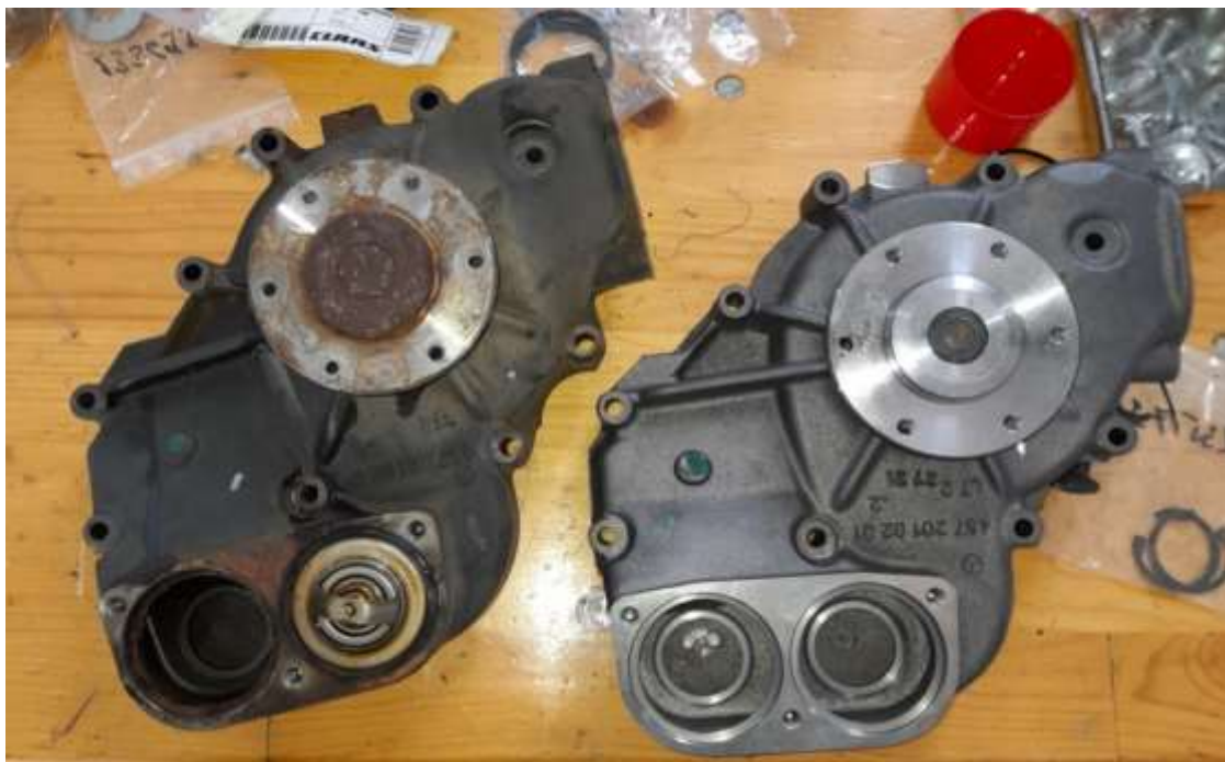
Slika 21. Prikazuje istrošenu vodenu pumpu (lijevo) i novu vodenu pumpu (desno) (Izvor: Vlastita fotografija)
