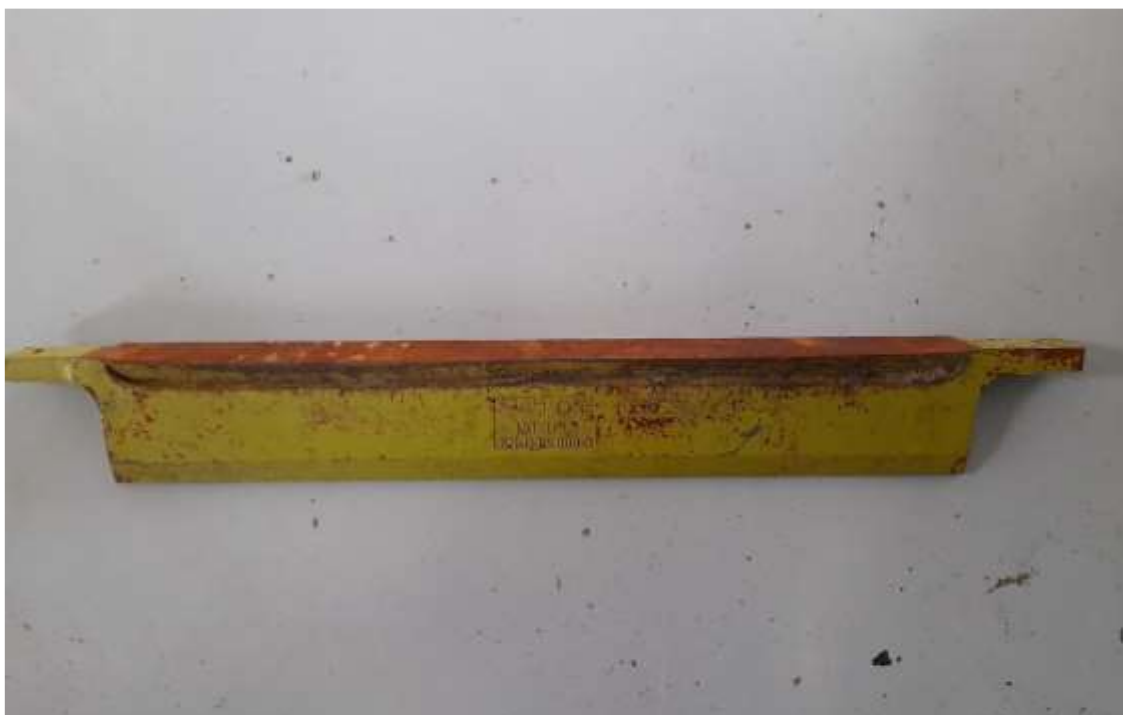
Slika 3. Prikazuje istrošenost i utjecaj korozije na čistaču glatkog valjka (Izvor: Vlastita fotografija)
