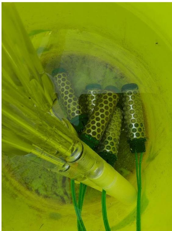
Slika 16. Watermark senzori u posudi s vodom
