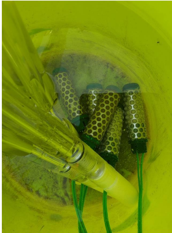
Slika 16. Watermark senzori u posudi s vodom
