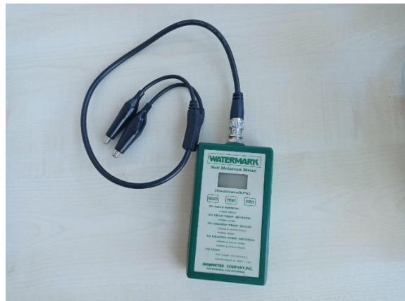
Slika 11. Watermark uređaj za mjerjenje vlage tla
