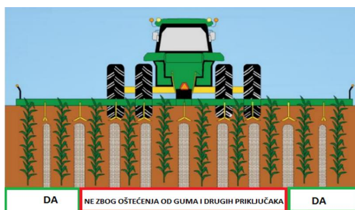
Slika 14. Prikaz prikladnog mjesta za postavljanje senzora
