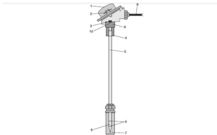
Tenziometar za mjerenje vlage tla. 1 - kućište, 2 - pojačalo signala, 3 - pretvarač pritiska, 4 - brtveni prsten, 5 - okomita cijev, 6 - ćelija tenziometra, 7 – zaštitni pokrov, 8 - ulaz, 9 - transportna brtva, 10 - indikator mjehurića
