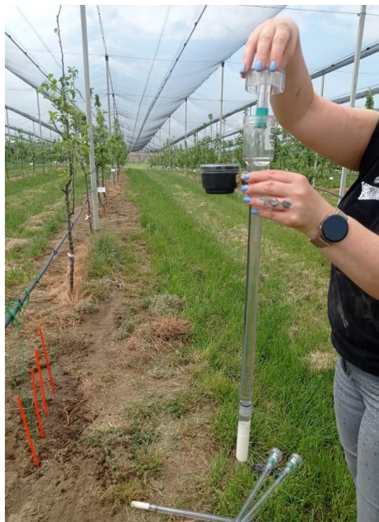
Slika 19. Punjenje senzora destiliranom vodom
