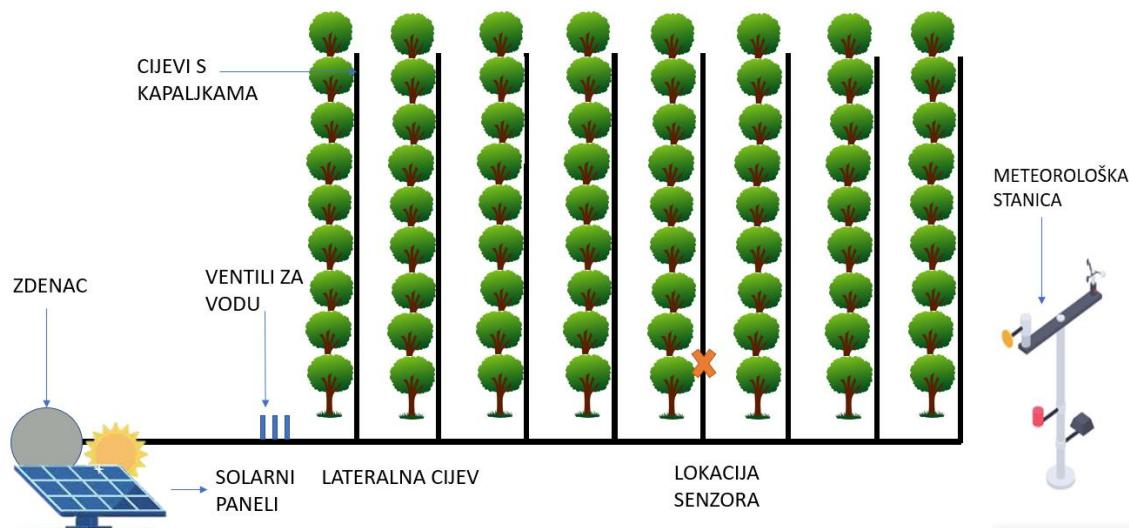
Slika 15. Shematski prikaz voćnjaka i položaja senzora za mjerjenje vlažnost tla
