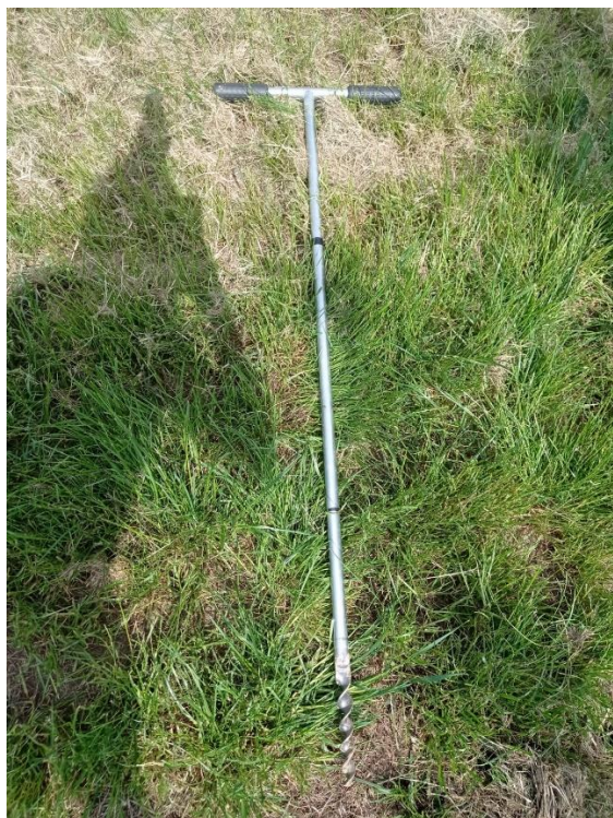
Slika 18. Svrđlo za postavljanje senzora u tlo
