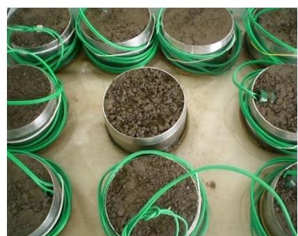
Slika 6. Umjeravanje senzora za mjerjenje
