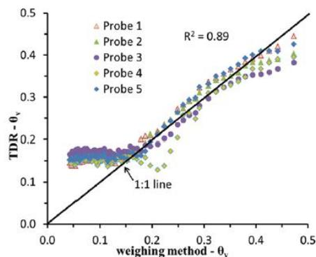
Grafikon 2. Odnos TDR mjerjenja i sadržaja vode u tlu mjerjen metodom gravimetrije
