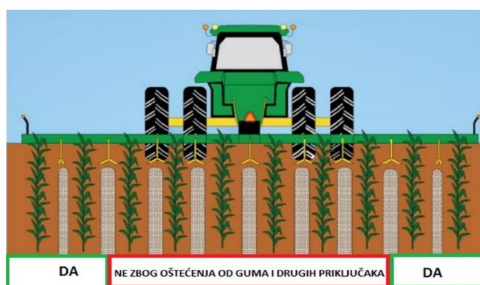
Slika 14. Prikaz prikladnog mjesta za postavljanje senzora
