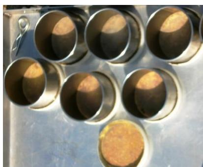
Slika 5. Cilindri po Kopeckom
