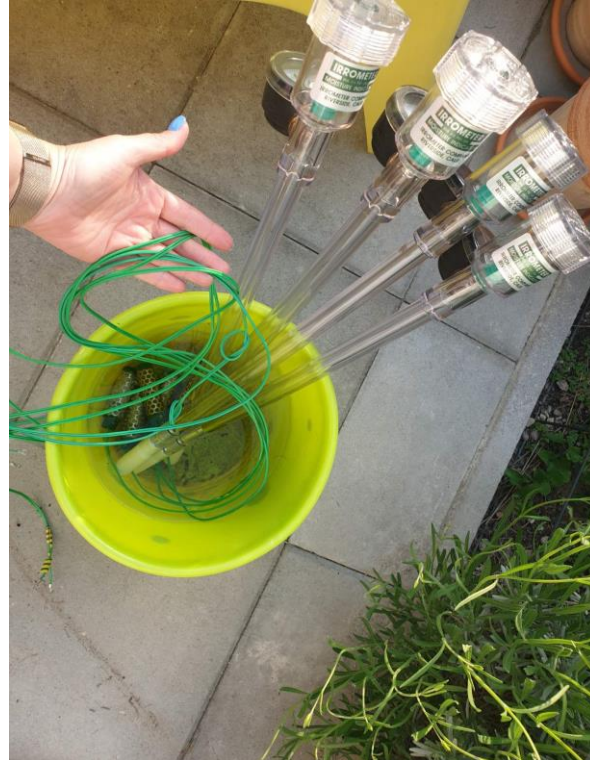
Slika 17. Tenziometri u posudi s vodom
