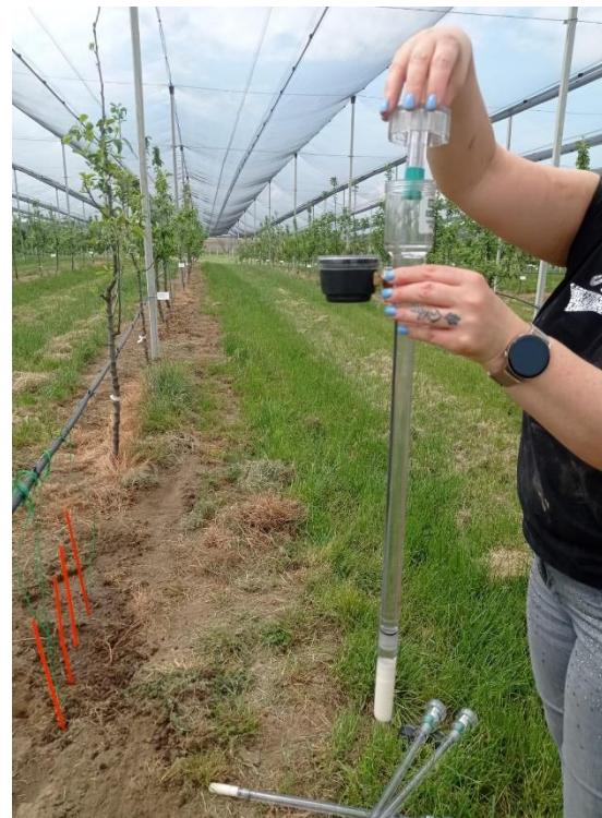
Slika 19. Punjenje senzora destiliranim vodom
