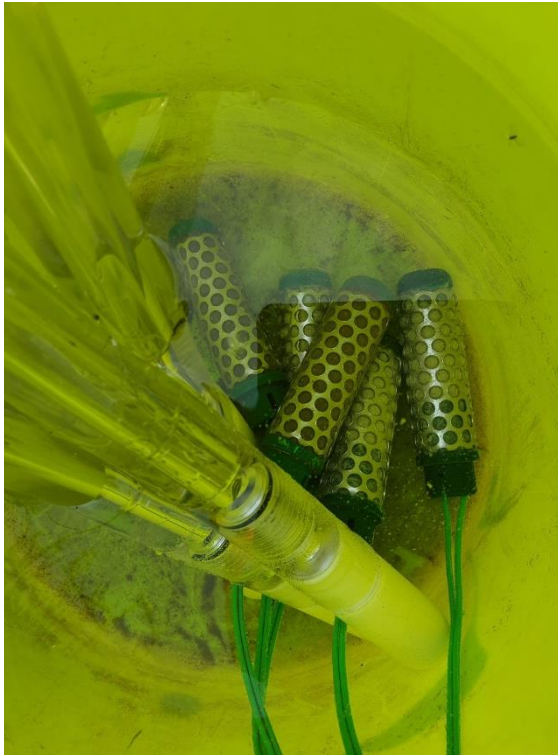
Slika 16. Watermark senzori u posudi s vodom
