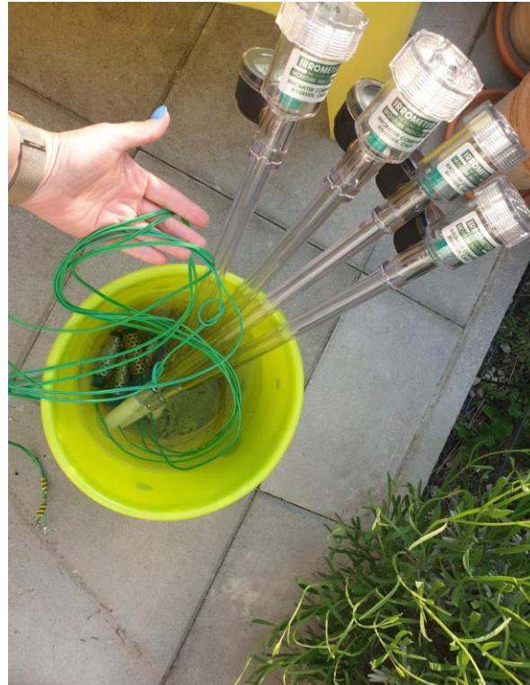
Slika 17. Tenziometri u posudi s vodom
