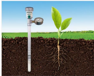
Slika 9. Tenziometar u dubini korijenovog sustava
