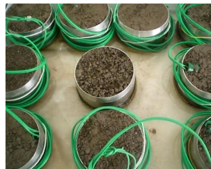
Slika 6. Umjeravanje senzora za mjerenje vlažnosti tla Fotografija: Marković, M. (2022.)
