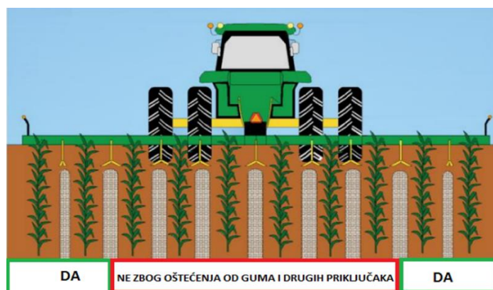
Slika 14. Prikaz prikladnog mjesta za postavljanje senzora
