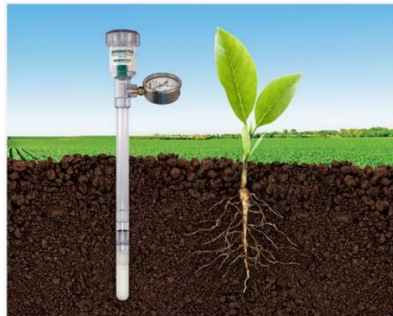
Slika 9. Tenziometar u dubini korijenovog sustava
