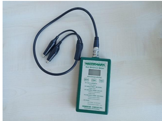
Slika 11. Watermark uređaj za mjerenje vlage tla
