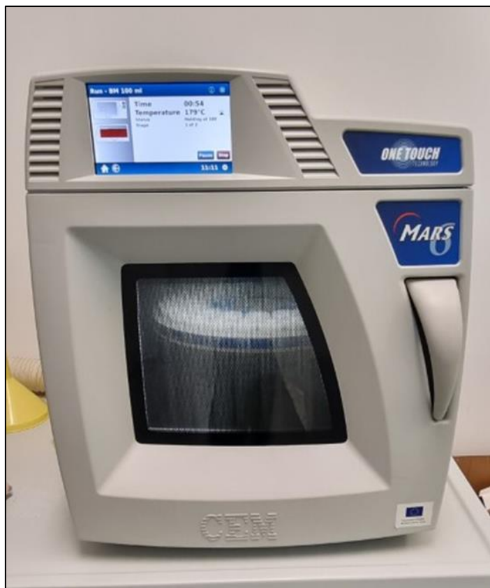
Slika 7. Razaranje uzoraka u mikrovalnoj peći
