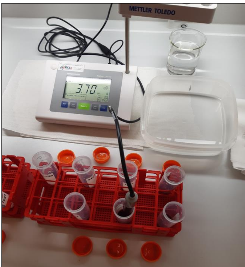
Slika 5. Mjerenje pH vrijednost uzoraka
