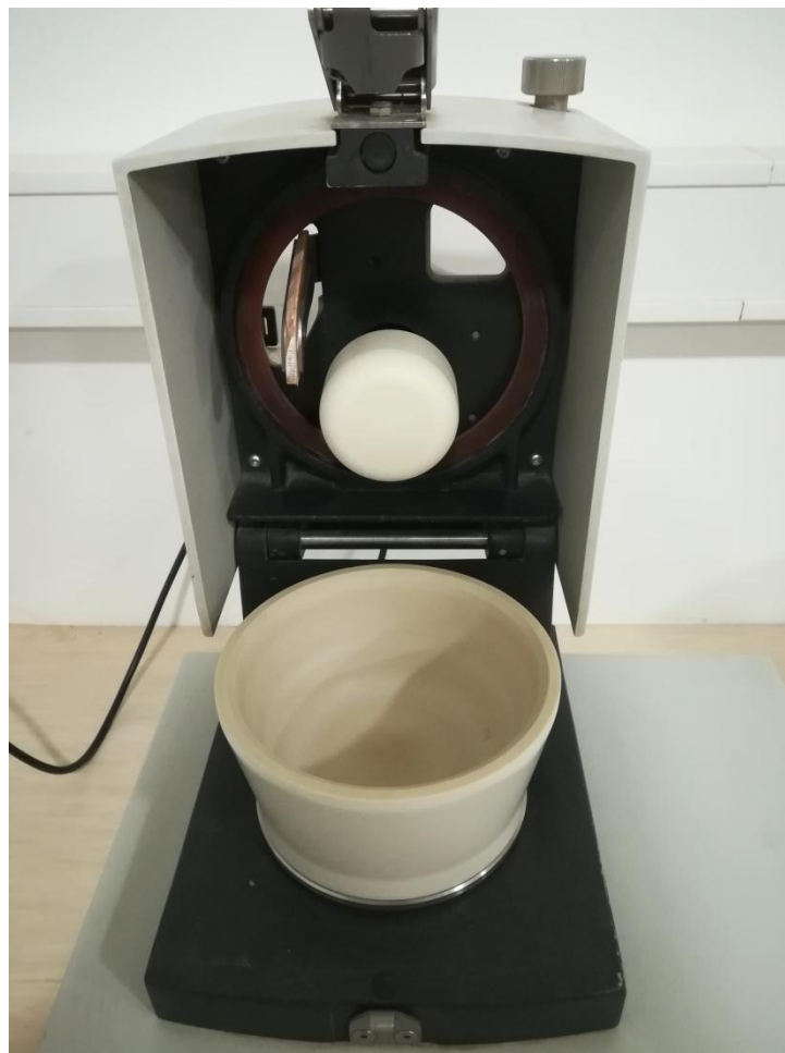
Slika 6. Mlin za mljevenje uzorka ječma (Izvor: autor)
